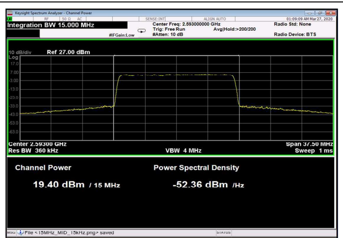
Figure 76: 64QAM 15MHz B.W.; 2593.0MHz, 30kHz
