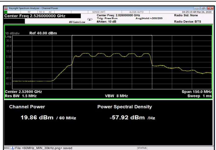
Figure 52: 16QAM 60MHz B.W.; 2526.0MHz, 60kHz
