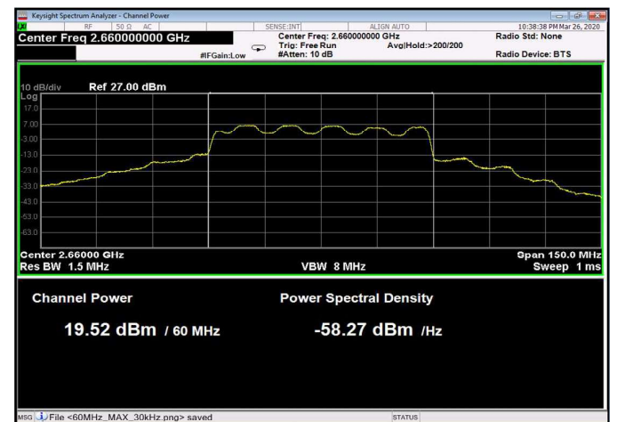
Figure 56: 16QAM 60MHz B.W.; 2660.0MHz, 60kHz
