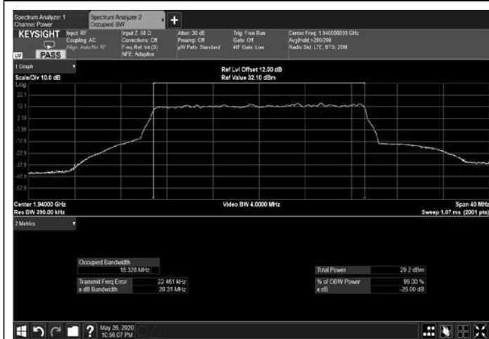
Figure 263: 64QAM 20MHz B.W.; 1940.0MHz, 30kHz Output
