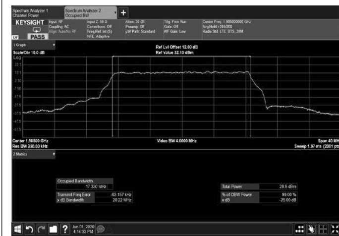
Figure 303: 256QAM 20MHz B.W.; 1985.0MHz, 60kHz Output
