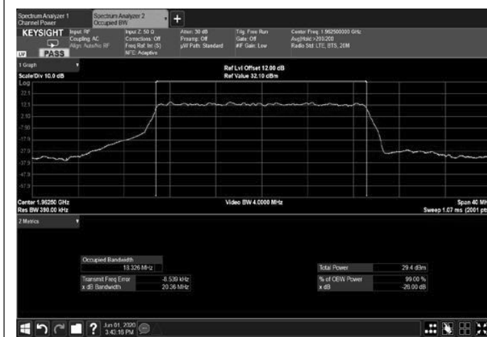
Figure 299: 256QAM 20MHz B.W.; 1962.5MHz, 30kHz Output
