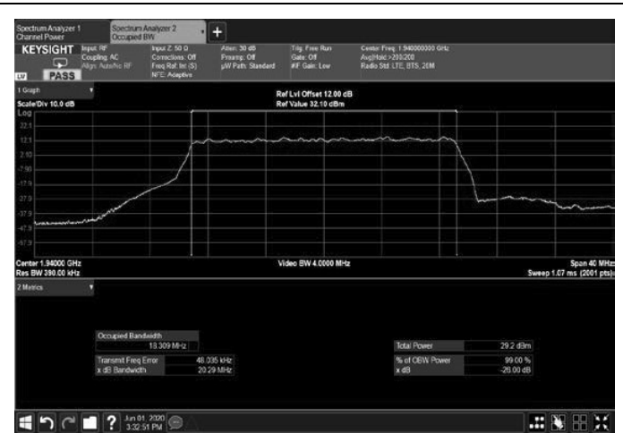
Figure 296: 256QAM 20MHz B.W.; 1940.0MHz, 30kHz Output
