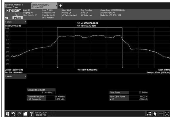
Figure 219: 16QAM 10MHz B.W.; 1990.0MHz, 60kHz Output
