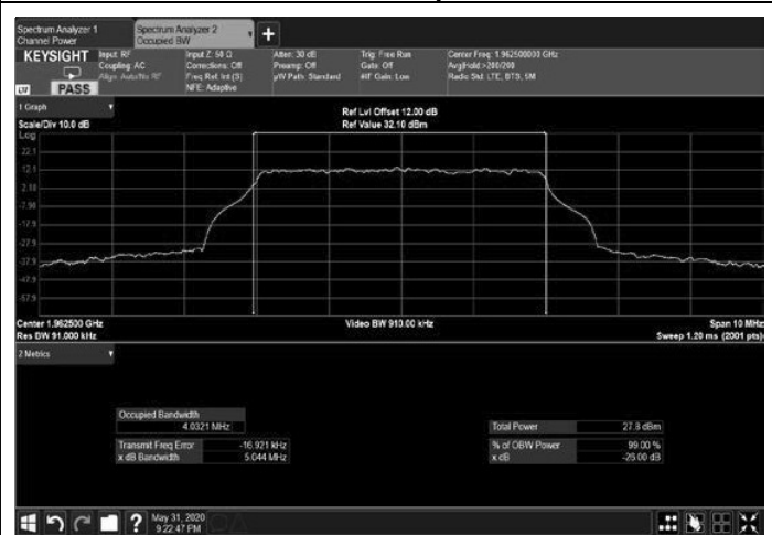
Figure 274: 256QAM 5MHz B.W.; 1962.5MHz, 30kHz Output
