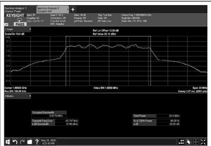
Figure 218: 16QAM 10MHz B.W.; 1990.0MHz, 30kHz Output
