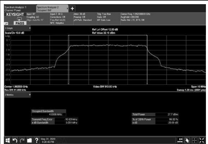
Figure 276: 256QAM 5MHz B.W.; 1992.5MHz, 30kHz Output
