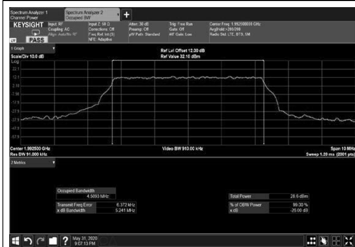
Figure 275: 256QAM 5MHz B.W.; 1992.5MHz, 15kHz Output
