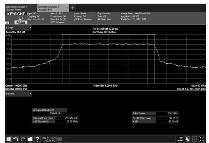
Figure 298: 256QAM 20MHz B.W.; 1962.5MHz, 15kHz Output
