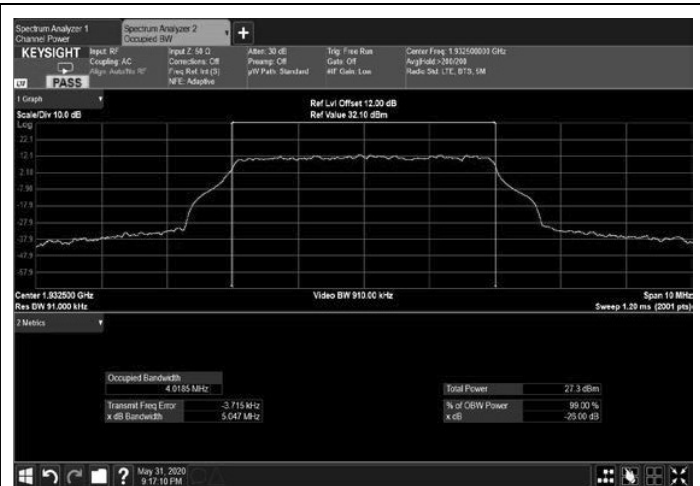
Figure 272: 256QAM 5MHz B.W.; 1932.5MHz, 30kHz Output
