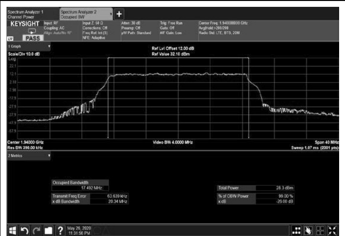
Figure 264: 64QAM 20MHz B.W.; 1940.0MHz, 60kHz Output
