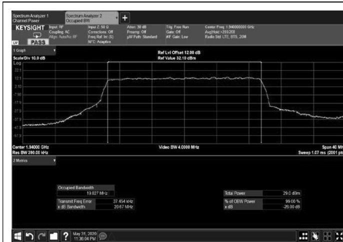
Figure 295: 256QAM 20MHz B.W.; 1940.0MHz, 15kHz Output
