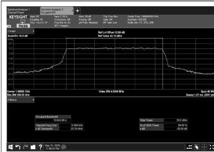
Figure 301: 256QAM 20MHz B.W.; 1985.0MHz, 15kHz Output
