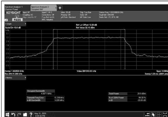
Figure 271: 256QAM 5MHz B.W.; 1932.5MHz, 15kHz Output
