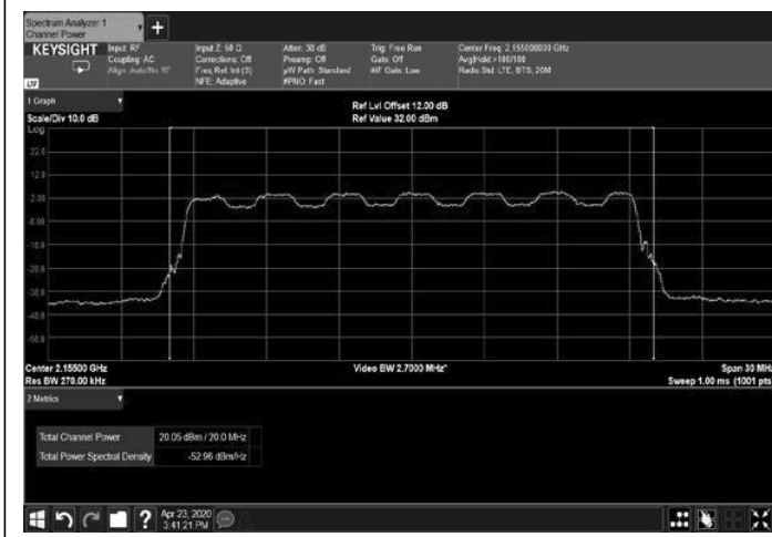
Figure 35: 16QAM 20MHz B.W.; 2155.0MHz, 30kHz
