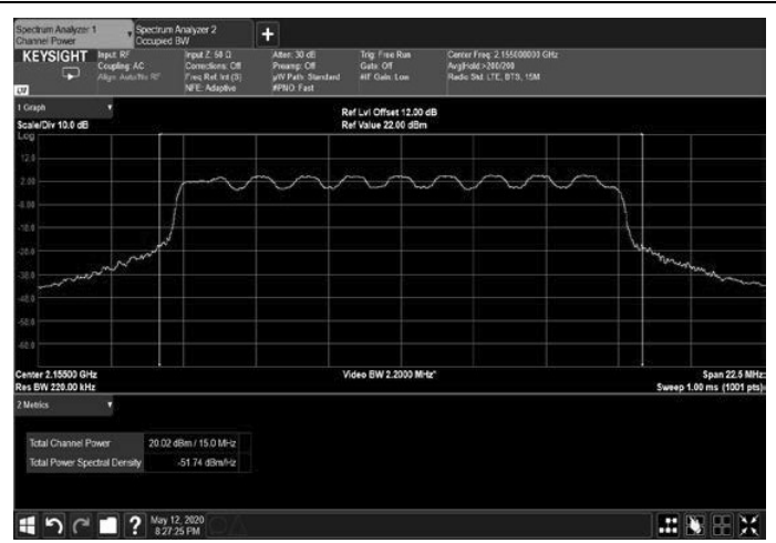
Figure 26: 16QAM 15MHz B.W.; 2155.0MHz, 30kHz
