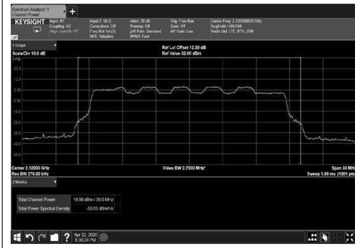
Figure 33: 16QAM 20MHz B.W.; 2120.0MHz, 60kHz
