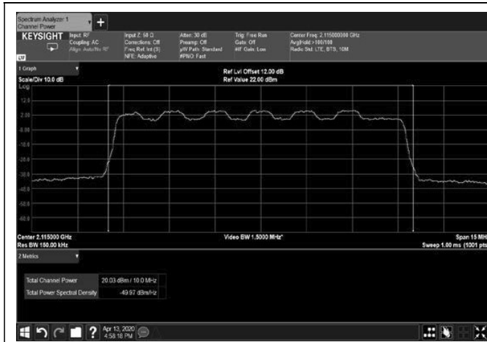
Figure 13: 16QAM 10MHz B.W.; 2115.0MHz, 15kHz
