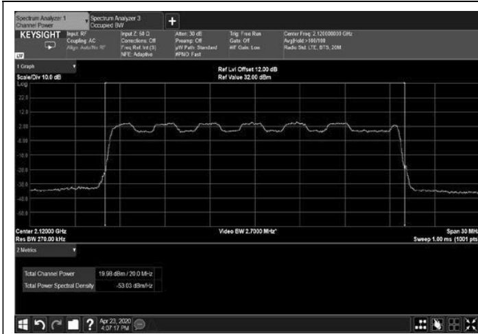
Figure 31: 16QAM 20MHz B.W.; 2120.0MHz, 15kHz
