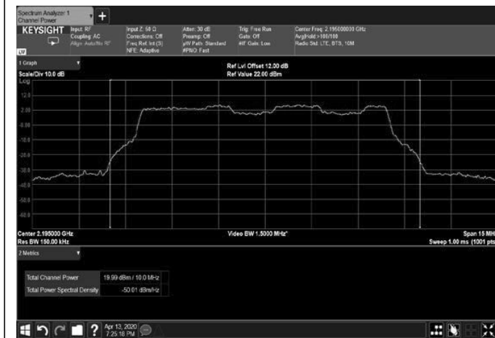
Figure 21: 16QAM 10MHz B.W.; 2195.0MHz, 60kHz
