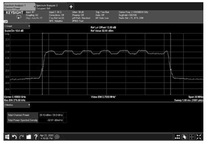
Figure 34: 16QAM 20MHz B.W.; 2155.0MHz, 15kHz
