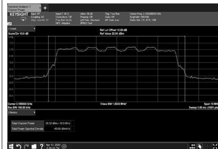
Figure 17: 16QAM 10MHz B.W.; 2155.0MHz, 30kHz
