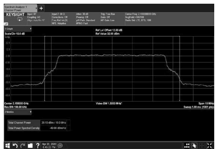
Figure 84: 256QAM 10MHz B.W.; 2115.0MHz, 60kHz
