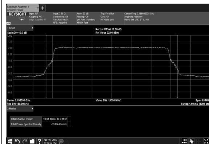
Figure 53: 64QAM 10MHz B.W.; 2195.0MHz, 30kHz
