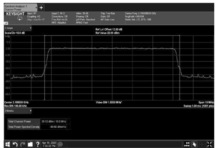
Figure 52: 64QAM 10MHz B.W.; 2195.0MHz, 15kHz
