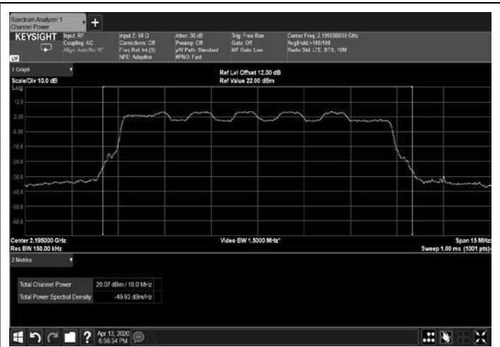
Figure 20: 16QAM 10MHz B.W.; 2195.0MHz, 30kHz
