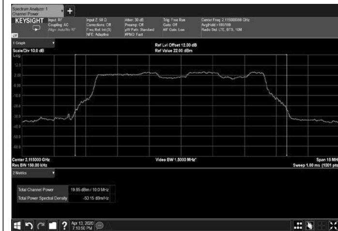
Figure 15: 16QAM 10MHz B.W.; 2115.0MHz, 60kHz
