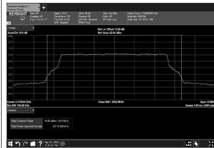
Figure 81: 256QAM 10MHz B.W.; 2115.0MHz, 60kHz
