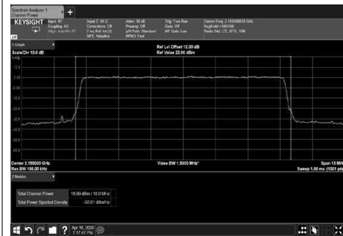
Figure 49: 64QAM 10MHz B.W.; 2155.0MHz, 15kHz
