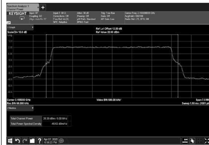
Figure 75: 256QAM 5MHz B.W.; 2155.0MHz, 15kHz
