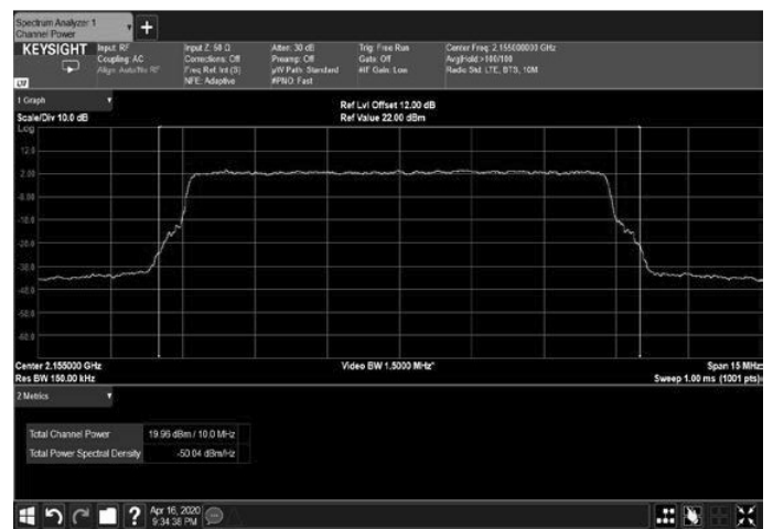
Figure 50: 64QAM 10MHz B.W.; 2155.0MHz, 30kHz
