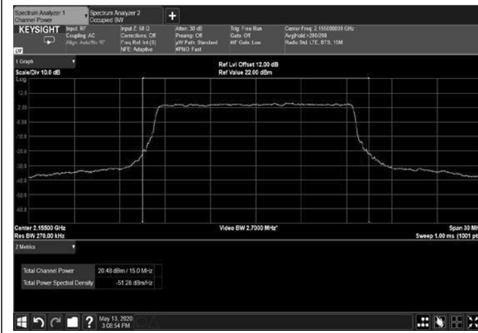
Figure 93: 256QAM 15MHz B.W.; 2155.0MHz, 60kHz
