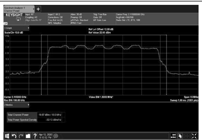
Figure 14: 16QAM 10MHz B.W.; 2115.0MHz, 30kHz
