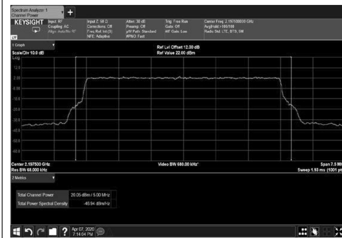
Figure 77: 256QAM 5MHz B.W.; 2179.5MHz, 15kHz
