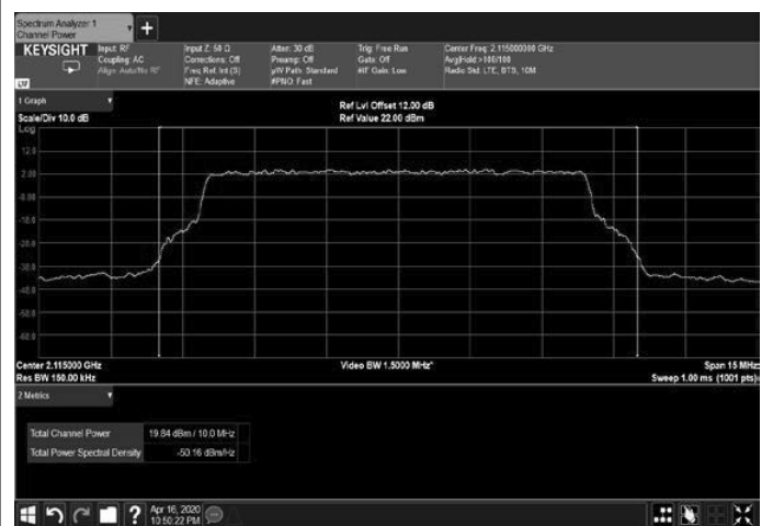
Figure 48: 64QAM 10MHz B.W.; 2115.0MHz, 60kHz
