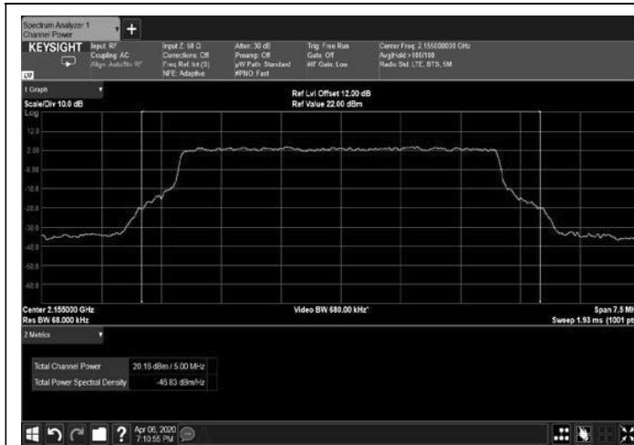
Figure 43: 64QAM 5MHz B.W.; 2155.0MHz, 30kHz
