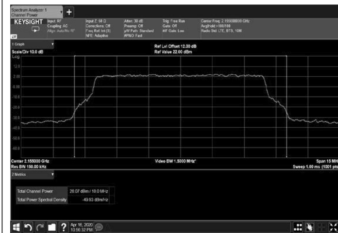
Figure 51: 64QAM 10MHz B.W.; 2155.0MHz, 60kHz
