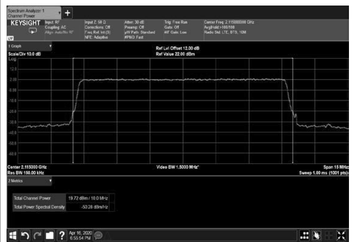
Figure 46: 64QAM 10MHz B.W.; 2115.0MHz, 15kHz
