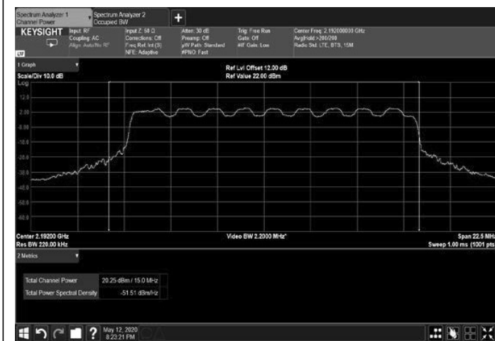
Figure 29: 16QAM 15MHz B.W.; 2192.0MHz, 30kHz
