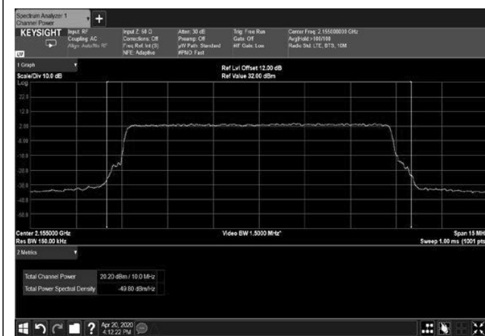
Figure 83: 256QAM 10MHz B.W.; 2115.0MHz, 30kHz
