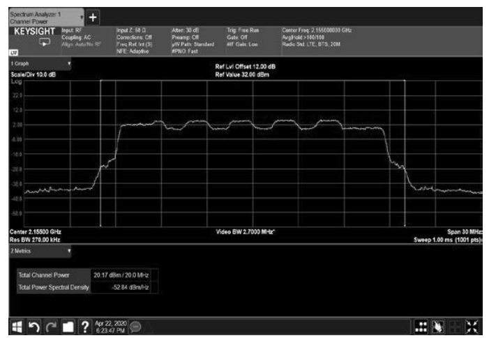
Figure 36: 16QAM 20MHz B.W.; 2155.0MHz, 60kHz
