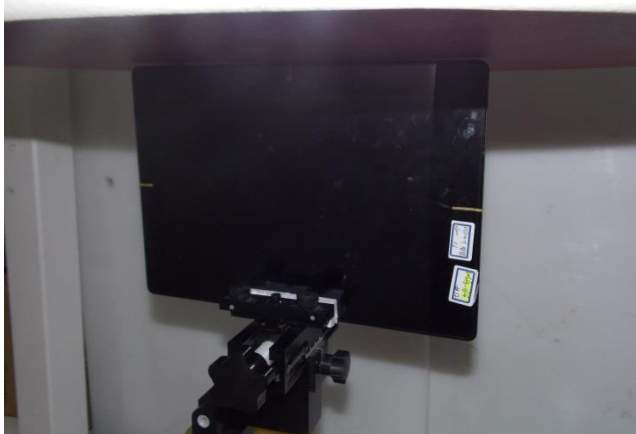
Edge 1 with Phantom 0 cm Gap
