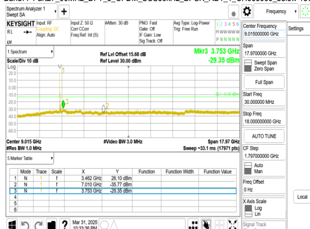
Band77-Part27 90MHz DFT s OFDM SCS30kHz BPSK RB1 1 CH633666 below 18G
