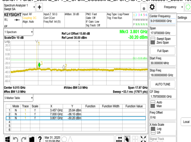
Band77-Part27 90MHz DFT s OFDM SCS30kHz BPSK RB1 1 CH633666 below 18G
