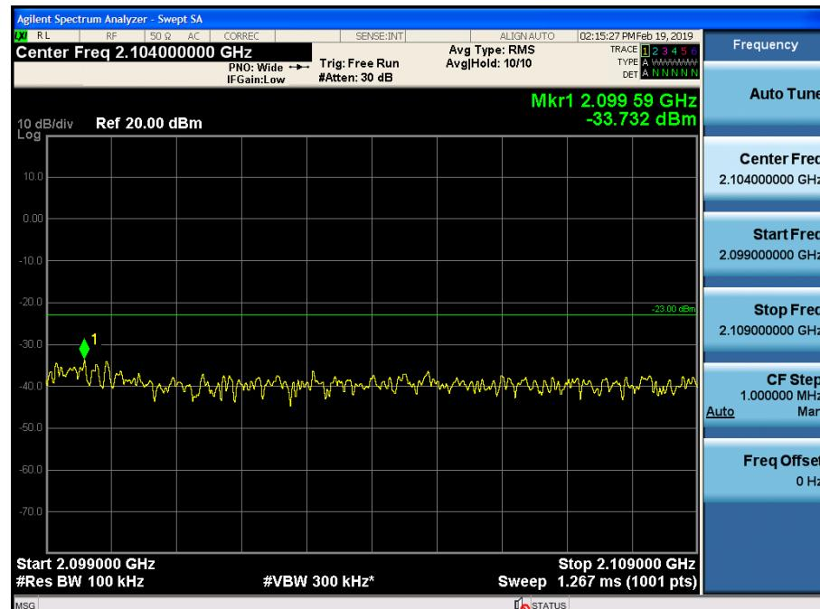
Spurious / AWS / Downlink / LTE 20 MHz / High / High Edge + 1 MHz ~ High Edge + 11 MHz
