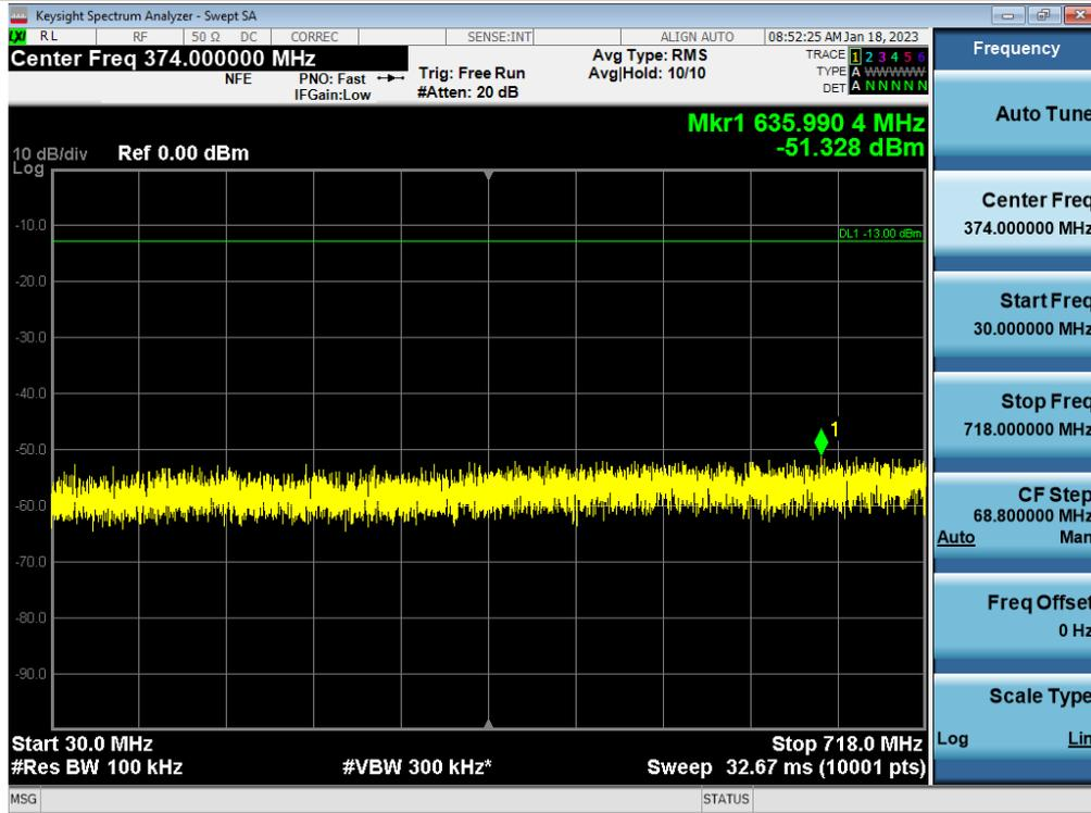
Spurious / Lower 700 MHz / Downlink / LTE 10 MHz / Low / Low Edge - 10 MHz ~ Low Edge
