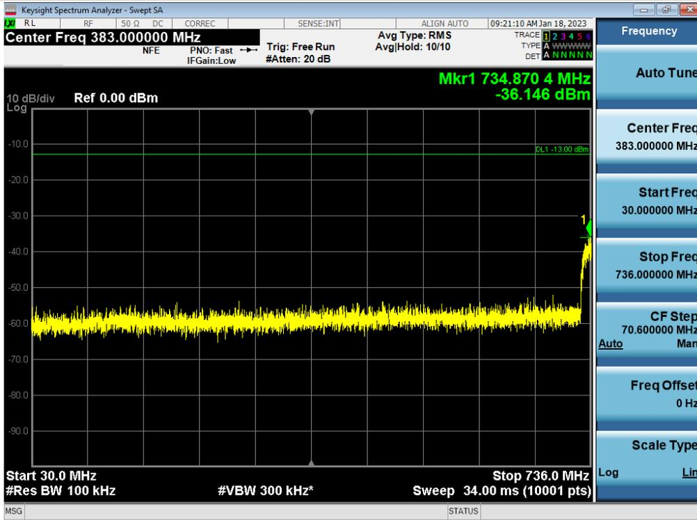
Spurious / Upper 700 MHz / Downlink / LTE 10 MHz / Low / Low Edge - 10 MHz ~ Low Edge
