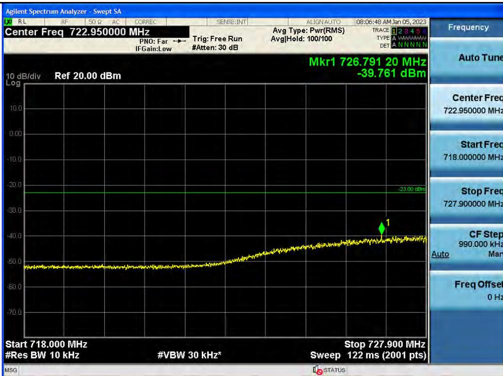
Spurious / Lower 700 MHz / Downlink / 5G NR 10 MHz / High / High Edge ~ High Edge + 10 MHz
