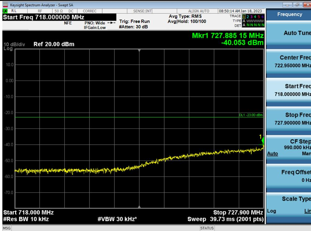
Spurious / Lower 700 MHz / Downlink / LTE 10 MHz / High / High Edge ~ High Edge + 10 MHz
