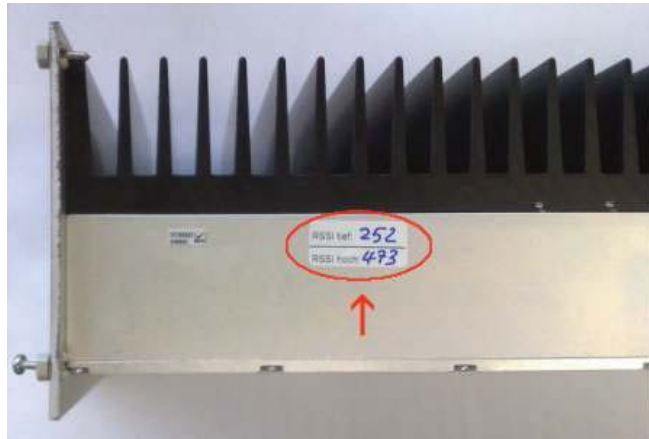
Fig. 9-1: Note the values "RSSI tief" (=RSSI low) and "RSSI hoch" (=RSSI high)
