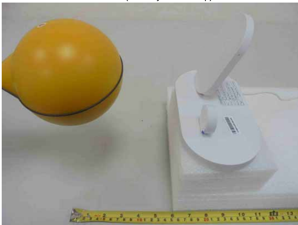
H -Field (Standby Mode - Top)
