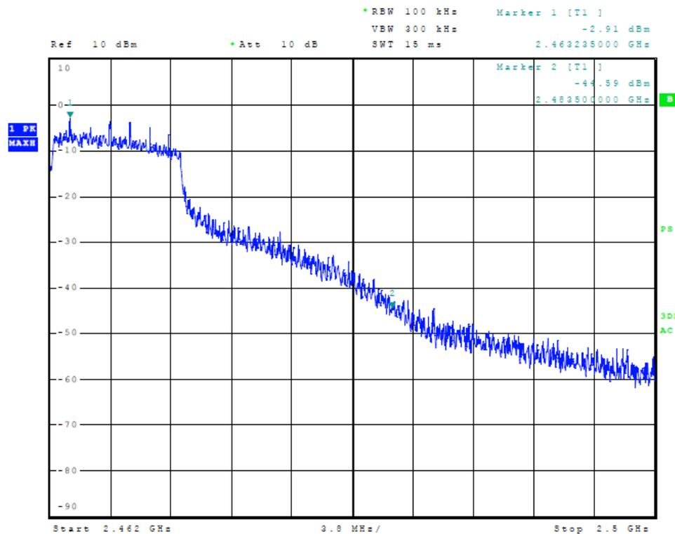
**Figure 10 Plot of Upper Band Edge (802.11 g-mode)**
