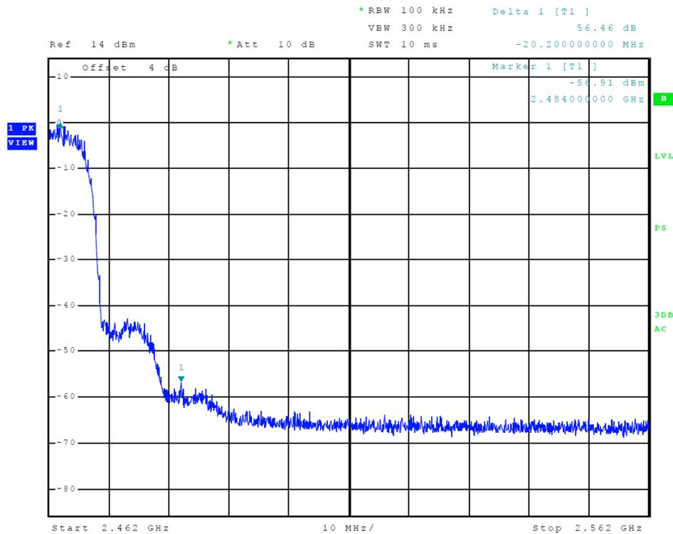
**Figure 20 Plot of Upper Band Edge (802.11 b-mode)**
