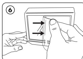
Retire la película protectora de la pantalla y conecte la alimentación al tomacorriente. Se iniciará la secuencia de arranque y, luego, se mostrará la pantalla de bienvenida.
