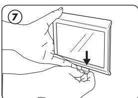
Si vous devez retirer l'afficheur, alignez l'outil de démontage avec la fente située au bas de l'appareil.
