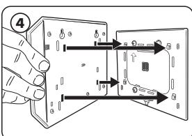
Alinee los ganchos de la placa de la carcasa de la fuente de alimentación con los orificios de la parte posterior de la unidad de visualización.
