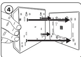
Aligner les crochets de la plaque du boîtier d'alimentation avec les trous situés à l'arrière de l'afficheur.
