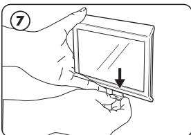
Si necesita quitar la pantalla, alinee la herramienta de extracción con la ranura en la parte inferior de la unidad.
