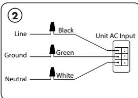
Haga que un electricista calificado conecte los cables de línea, a tierra y neutro con conectores de rotación.
