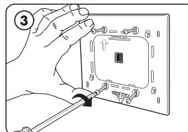
Fije la placa de la carcasa de la fuente de alimentación con los cuatro tornillos proporcionados.
