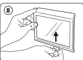
Tout en soutenant l'afficheur et en exerçant une légère pression vers le haut avec l'autre main, poussez l'outil de démontage vers le haut dans la fente et l'appareil se soulevera et se détachera des crochets de montage.
