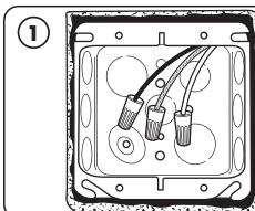
Assurez-vous qu'un électricien qualifié a installé une boîte de jonction fonctionnelle de 10 x 10 x 3,81 cm (4" x 4" x 1,5") avec plaque adaptatrice et les spécifications électriques appropriées à l'emplacement de l'installation.
