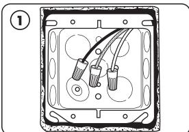
Asegúrese de que un electricista calificado haya instalado una caja múltiple de 4" x 4" x 1.5" que funcione, con una placa adaptadora y las especificaciones eléctricas correctas en el lugar de instalación.
