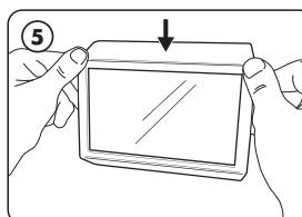
Una vez que se hayan insertado los cuatro ganchos en los orificios, presione suavemente la pantalla contra la pared y hacia abajo hasta que se escuche un clic.
