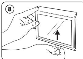
Mientras sostiene y presiona suavemente hacia arriba la pantalla con la otra mano, presione la herramienta de extracción hacia arriba en la ranura y la unidad se levantará y se soltará de los ganchos de montaje.
