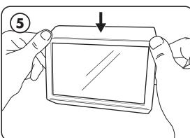
Une fois les quatre crochets insérés dans les trous, pressez doucement l'afficheur contre le mur et vers le bas jusqu'à ce qu'un déclic se fasse entendre.
