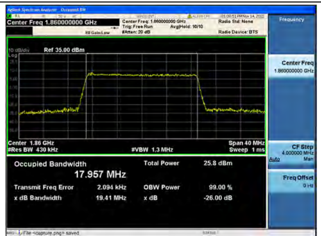
Band2 / 20MHz / 64QAM/ Low CH
