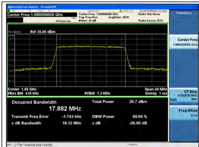
Band2 / 20MHz / QPSK/ Mid CH
