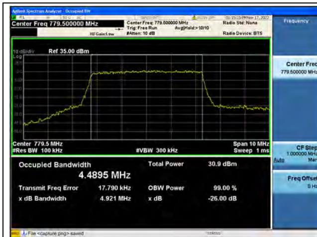
Band13 / 5MHz / QPSK/ Low CH
