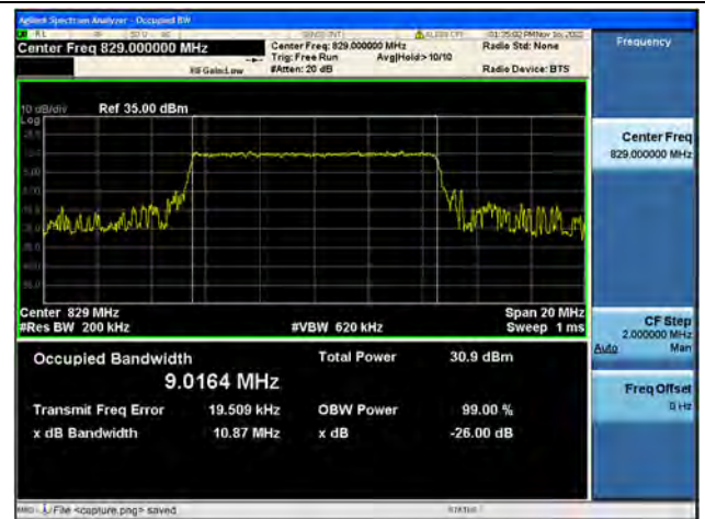
Band5 / 10MHz / QPSK/ Low CH
