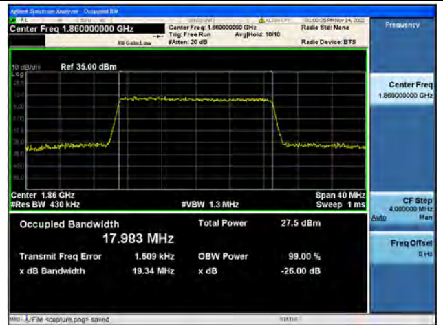
Band2 / 20MHz / QPSK/ Low CH
