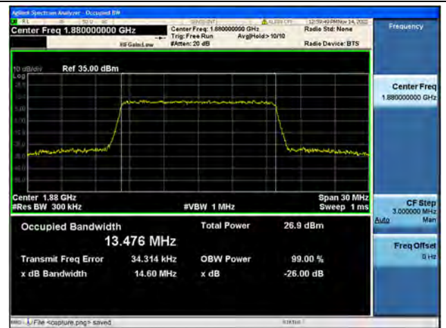
Band2 / 15MHz / QPSK/ Mid CH
