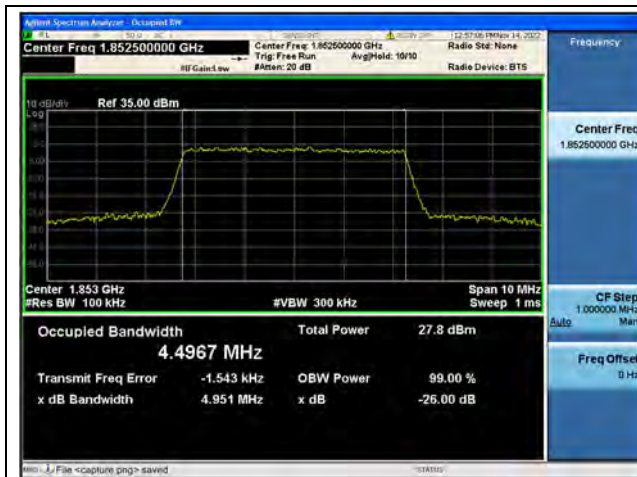
Band2 / 5MHz / QPSK/ Low CH
