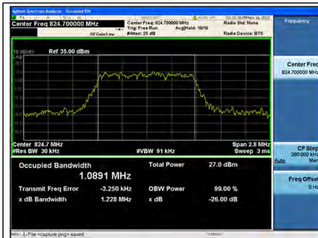
Band5 / 1.4MHz / QPSK/ Low CH
