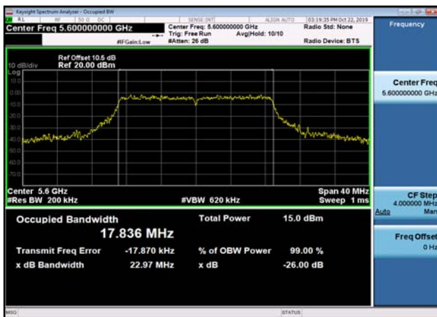
U-NII-2c 26dB Bandwidth-802.11ac(40MHz),5510MHz
