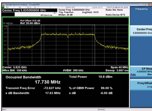
U-NII-3 6dB Bandwidth-802.11ac(20MHz) ,5825MHz
