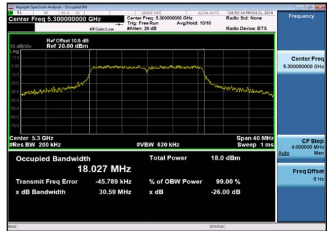
U-NII-2a 26dB Bandwidth-802.11n(40MHz) ,5270MHz
