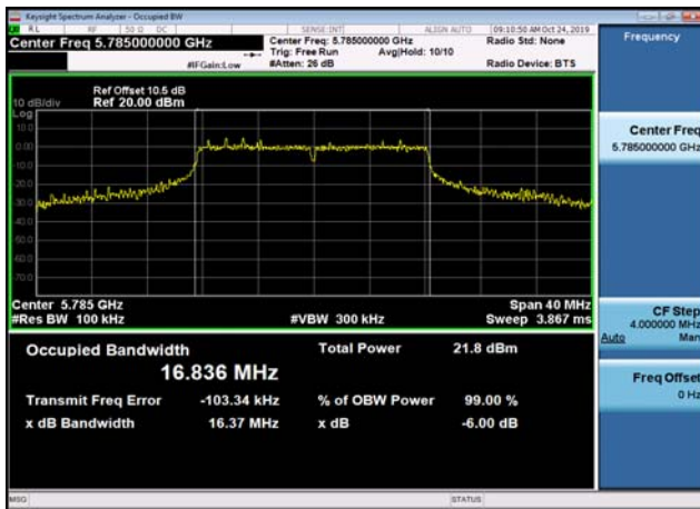
U-NII-3 6dB Bandwidth-802.11ac(20MHz) ,5745MHz
