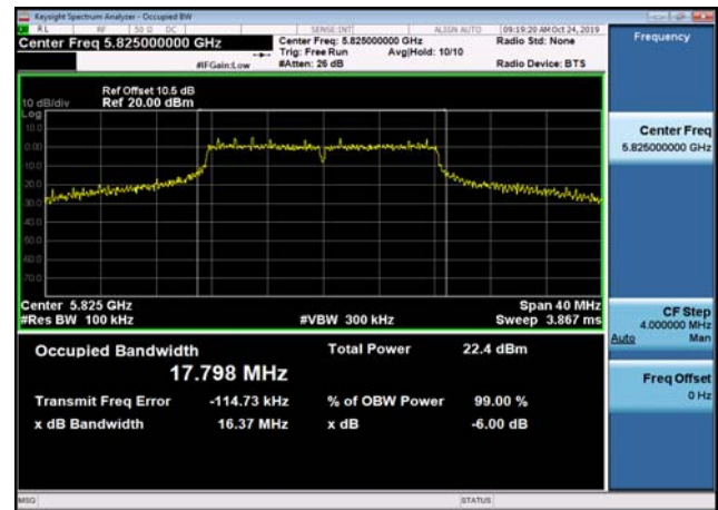
U-NII-3 6dB Bandwidth-802.11ac(20MHz) ,5785MHz
