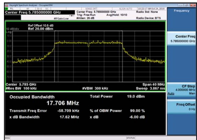
U-NII-3 6dB Bandwidth-802.11ac(40MHz) ,5755MHz
