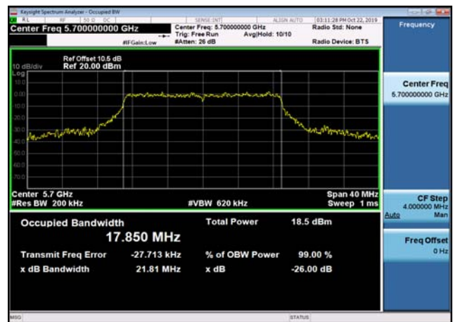
U-NII-2c 26dB Bandwidth-802.11ac(40MHz),5590MHz
