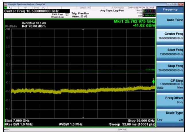
U-NII-2a ,Plot 1,Band Edge-802.11n(40 MHz),5310MHz
