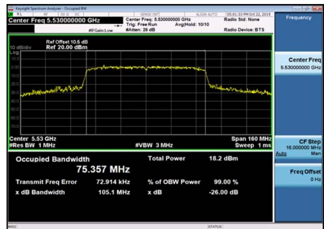
U-NII-2c 26dB Bandwidth-802.11ac(80MHz),5530MHz
