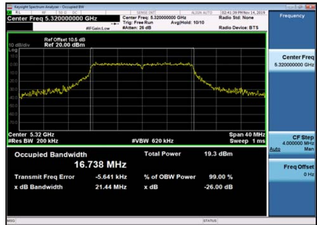
U-NII-2a 26dB Bandwidth-802.11ac(20MHz),5300MHz
