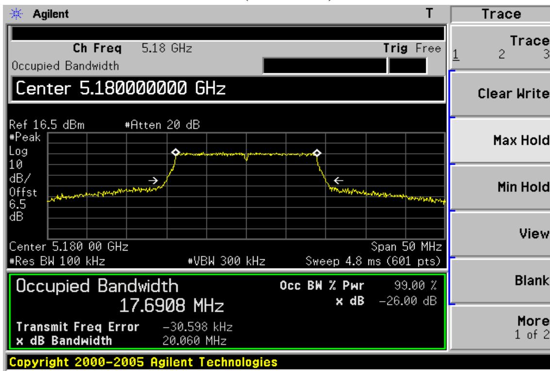
**26dB Band Width Test Data CH-Low (5220 MHz)**
