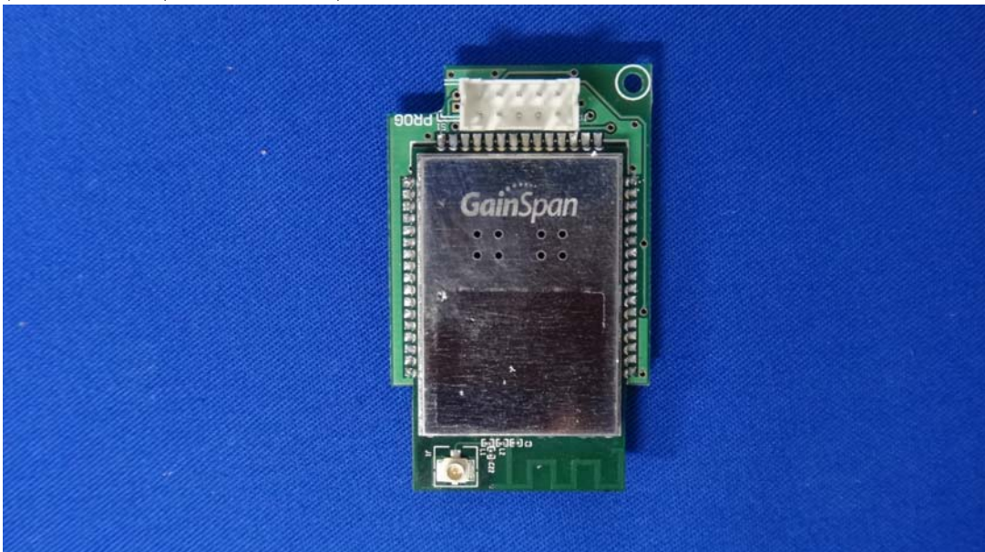
(10) EUT Photo (WLAN Module)
