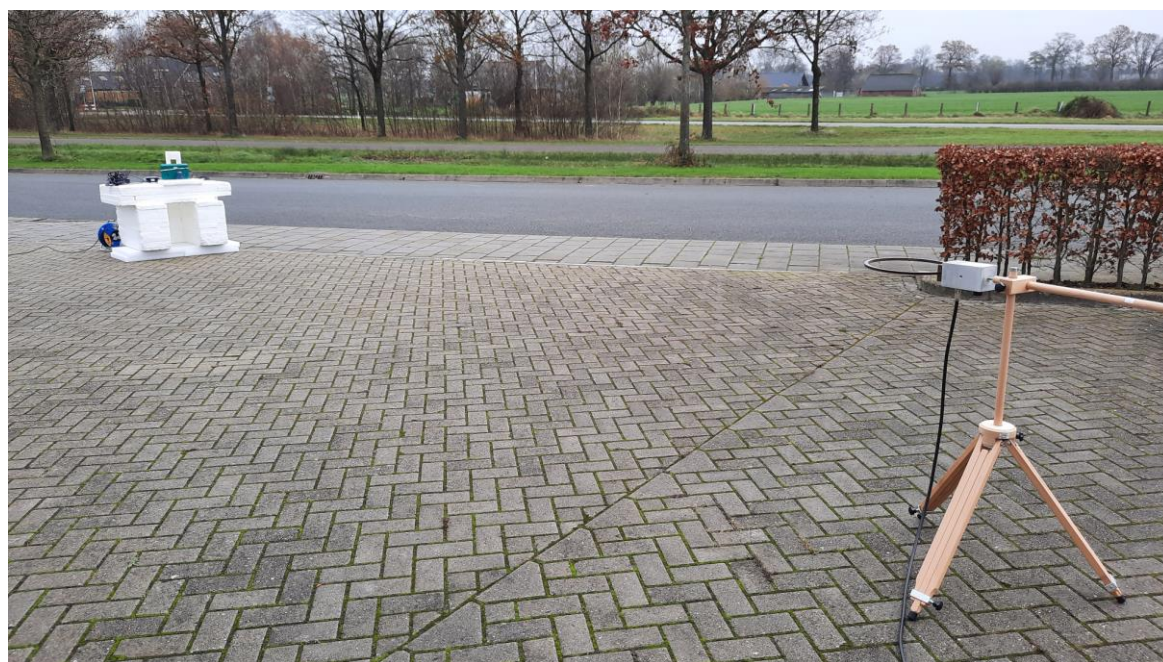
Setup EUT @10m (Z-orientation shown)
