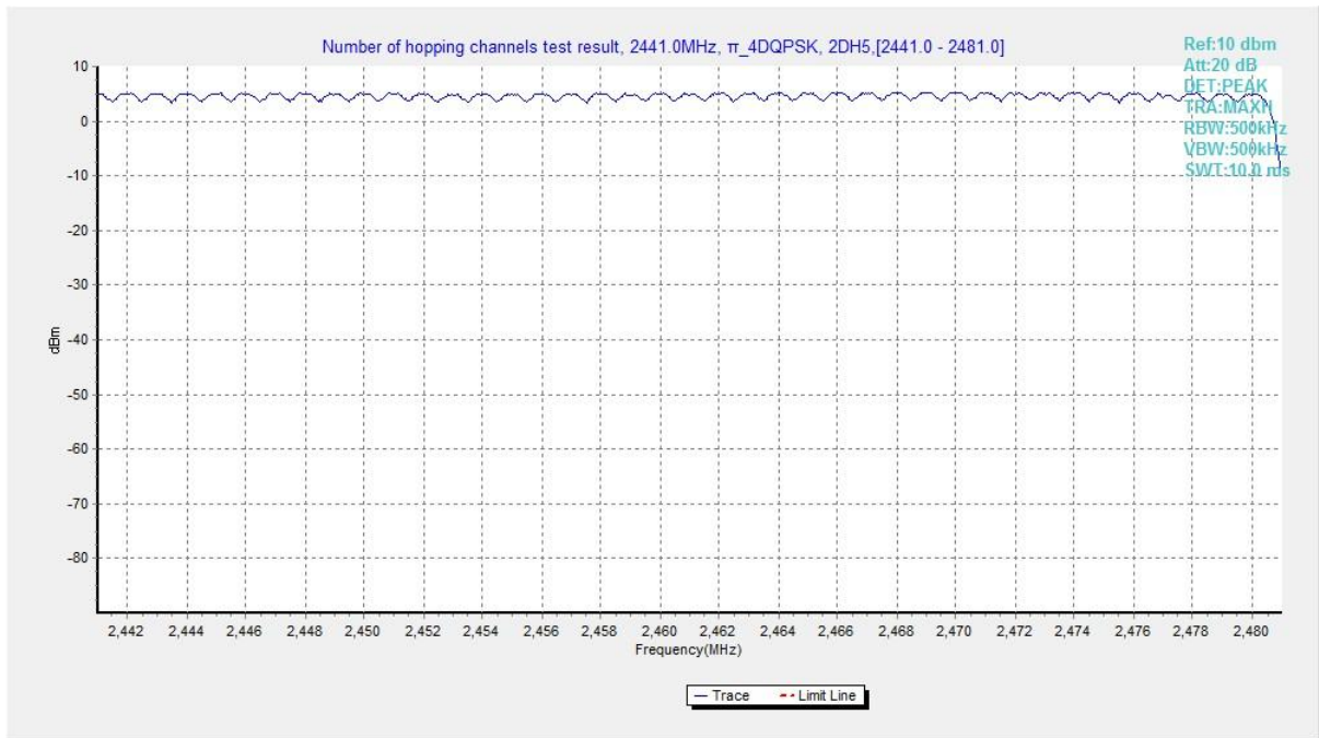
Fig. 78 Hopping channel ch40 ~ ch78 ( \pi/4 DQPSK)
