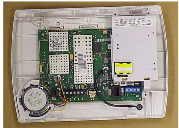
**THE DAUGHTER BOARD WITH THE GSM MODULE MOUNTED ON THE RIGHT SIDE OF THE INSIDE REAR PLASTIC.**
