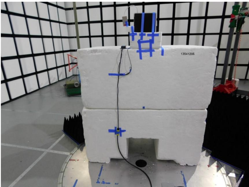
RADIATED PHOTO (>1GHz ANTENNA A + ANTENNA B)
