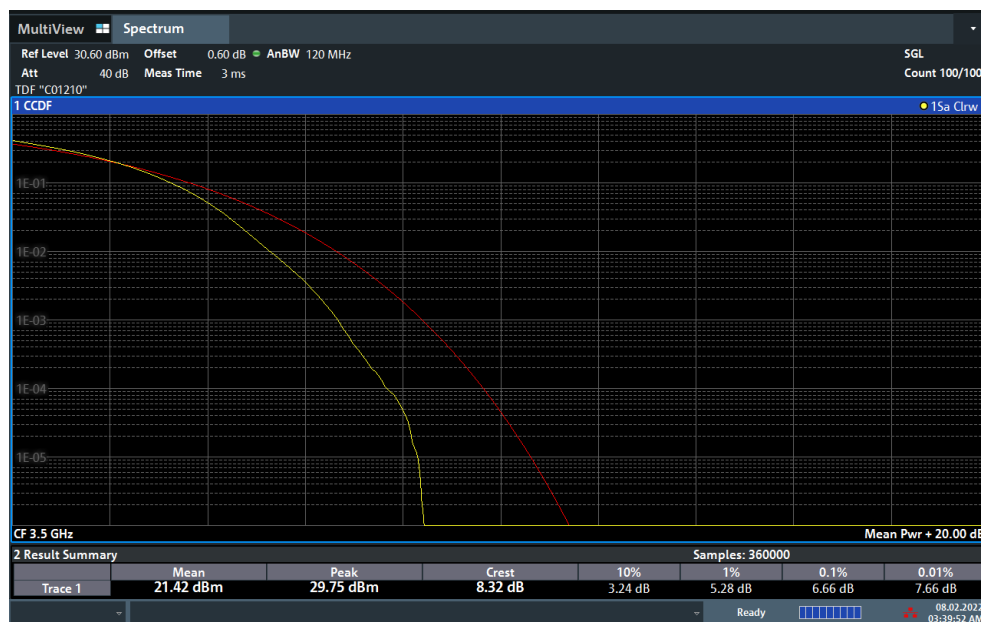
Plot 7-153. PAR Plot (NR Band n77 - 100MHz DFT-s-OFDM 256-QAM - Full RB)
