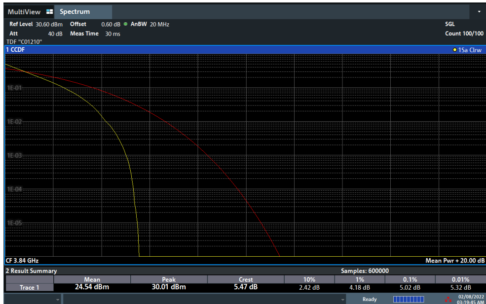
Plot 7-155. PAR Plot (NR Band n77 - 20MHz DFT-s-OFDM QPSK - Full RB)
