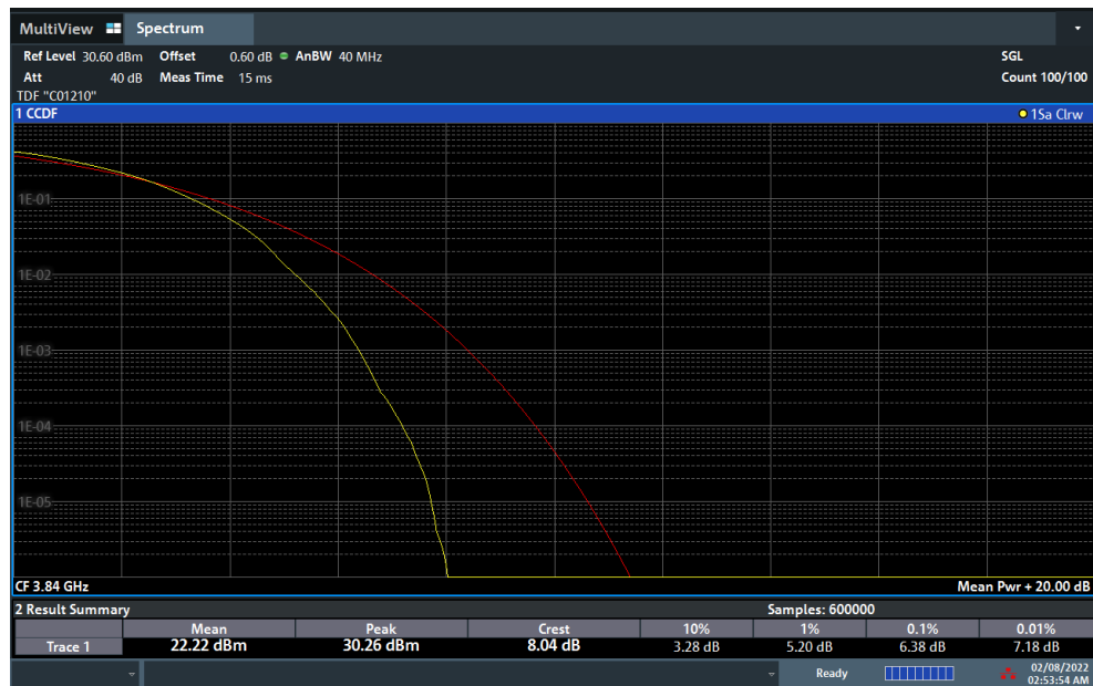
Plot 7-177. PAR Plot (NR Band n77 - 60MHz DFT-s-OFDM 64-QAM - Full RB)
