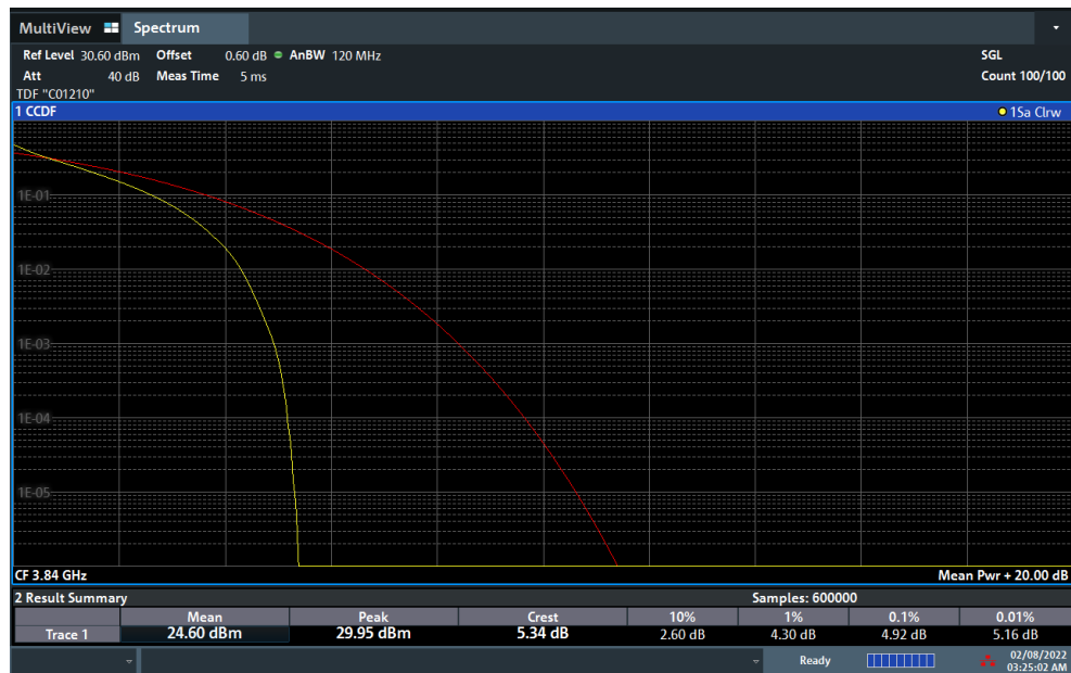
Plot 7-195. PAR Plot (NR Band n77 - 100MHz DFT-s-OFDM QPSK - Full RB)
