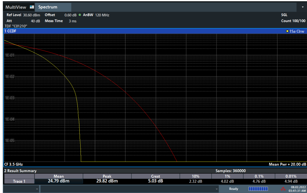
Plot 7-145. PAR Plot (NR Band n77 - 90MHz DFT-s-OFDM QPSK - Full RB)
