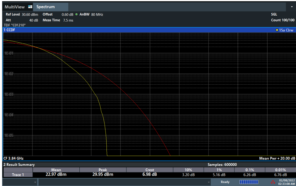
Plot 7-182. PAR Plot (NR Band n77 - 70MHz DFT-s-OFDM 64-QAM - Full RB)
