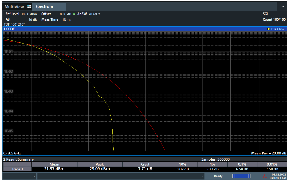
Plot 7-113. PAR Plot (NR Band n77 - 20MHz DFT-s-OFDM 256-QAM - Full RB)
