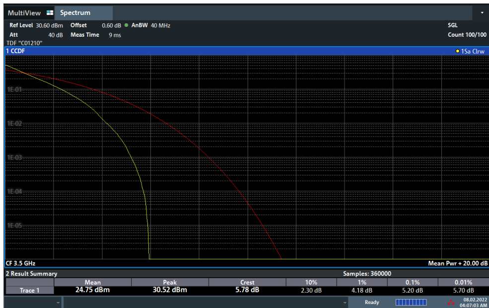
Plot 7-120. PAR Plot (NR Band n77 - 40MHz DFT-s-OFDM QPSK - Full RB)
