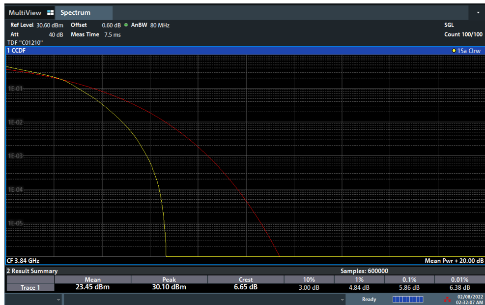
Plot 7-181. PAR Plot (NR Band n77 - 70MHz DFT-s-OFDM 16-QAM - Full RB)
