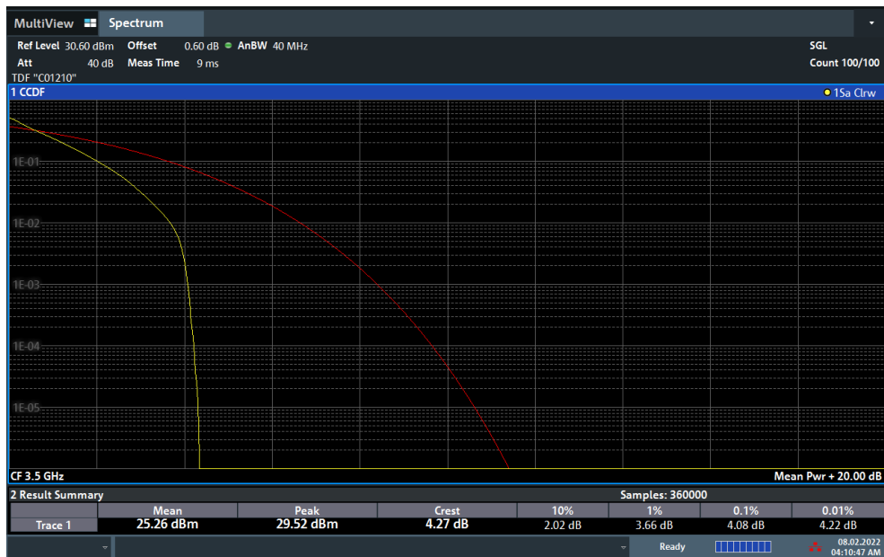
Plot 7-114. PAR Plot (NR Band n77 - 30MHz DFT-s-OFDM \pi/2 BPSK - Full RB)
