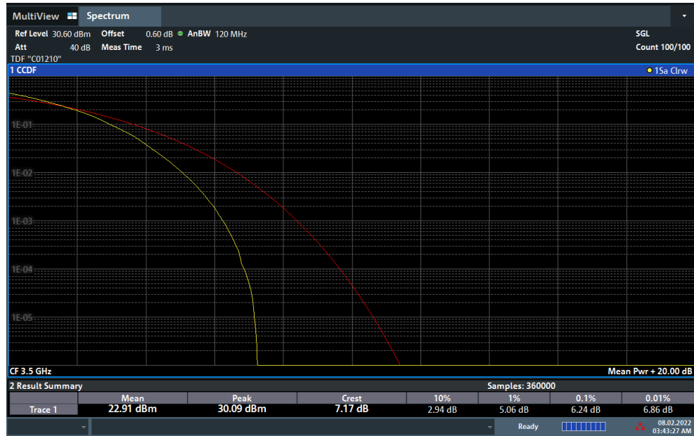
Plot 7-147. PAR Plot (NR Band n77 - 90MHz DFT-s-OFDM 64-QAM - Full RB)
