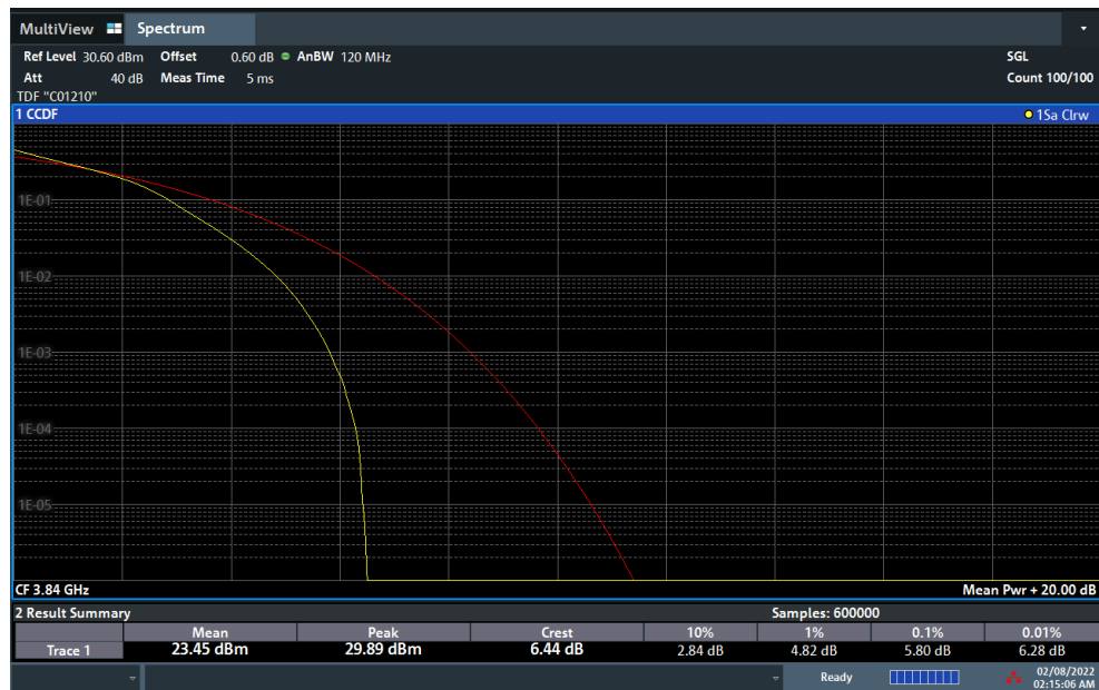
Plot 7-191. PAR Plot (NR Band n77 - 90MHz DFT-s-OFDM 16-QAM - Full RB)
