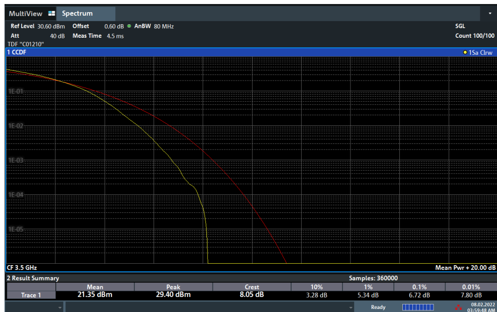
Plot 7-133. PAR Plot (NR Band n77 - 60MHz DFT-s-OFDM 256-QAM - Full RB)
