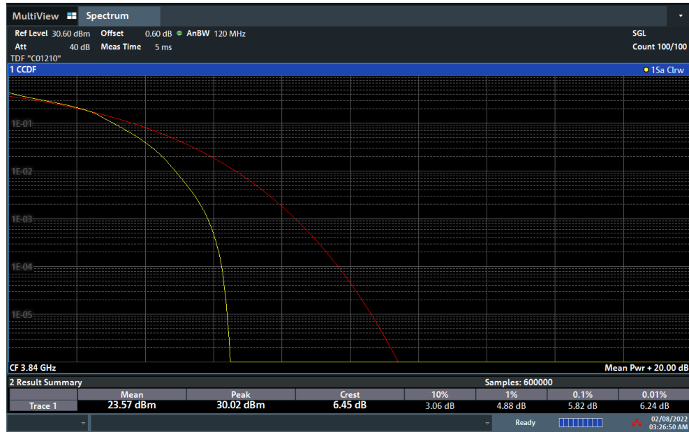
Plot 7-196. PAR Plot (NR Band n77 - 100MHz DFT-s-OFDM 16-QAM - Full RB)
