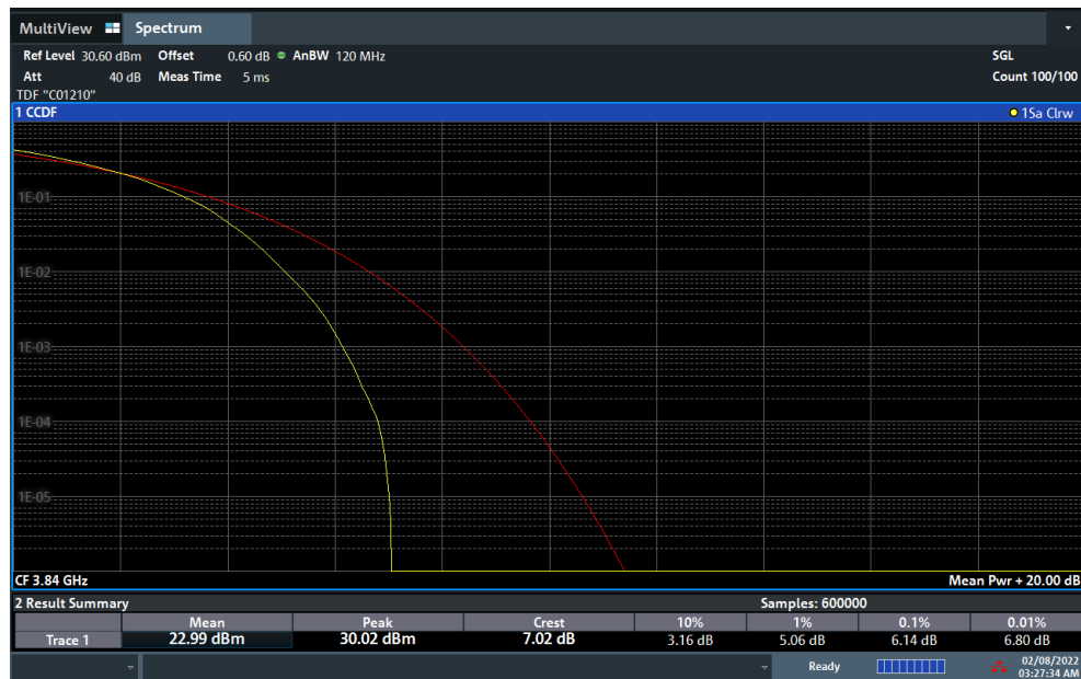
Plot 7-197. PAR Plot (NR Band n77 - 100MHz DFT-s-OFDM 64-QAM - Full RB)
