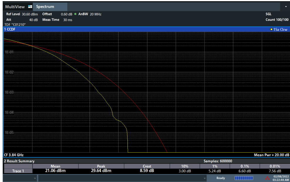
Plot 7-158. PAR Plot (NR Band n77 - 20MHz DFT-s-OFDM 256-QAM - Full RB)
