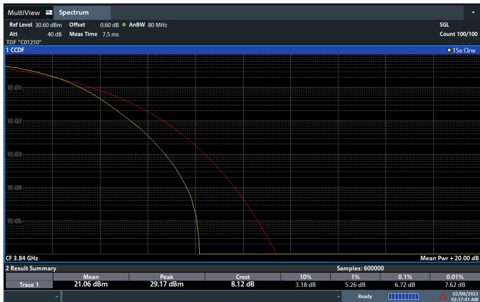
Plot 7-183. PAR Plot (NR Band n77 - 70MHz DFT-s-OFDM 256-QAM - Full RB)
