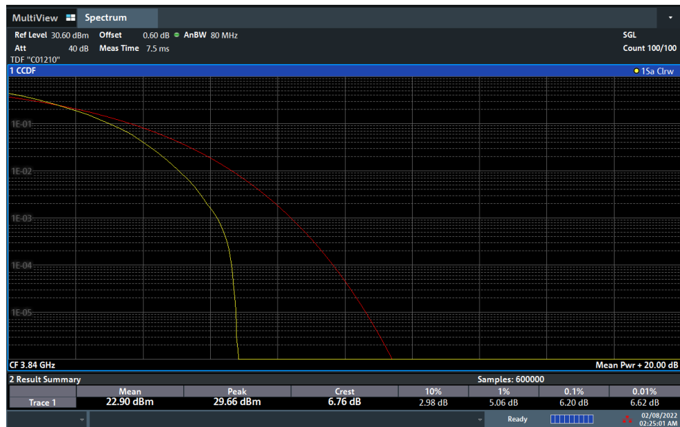
Plot 7-187. PAR Plot (NR Band n77 - 80MHz DFT-s-OFDM 64-QAM - Full RB)
