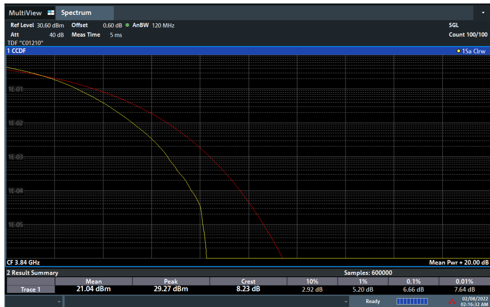
Plot 7-193. PAR Plot (NR Band n77 - 90MHz DFT-s-OFDM 256-QAM - Full RB)
