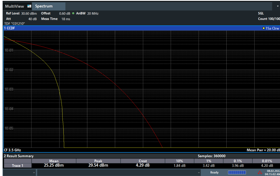
Plot 7-109. PAR Plot (NR Band n77 - 20MHz DFT-s-OFDM \pi/2 BPSK - Full RB)
