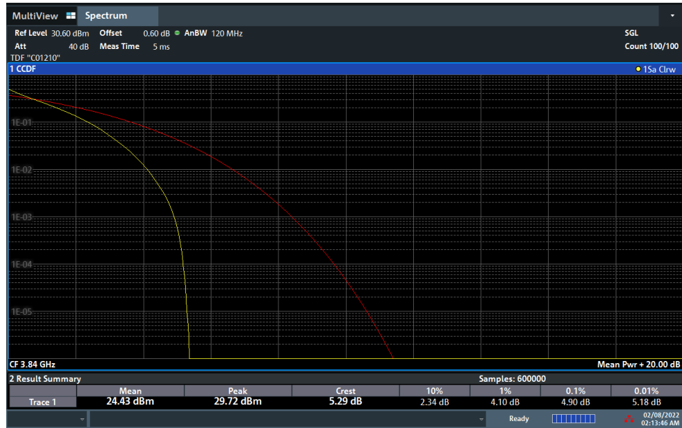
Plot 7-190. PAR Plot (NR Band n77 - 90MHz DFT-s-OFDM QPSK - Full RB)
