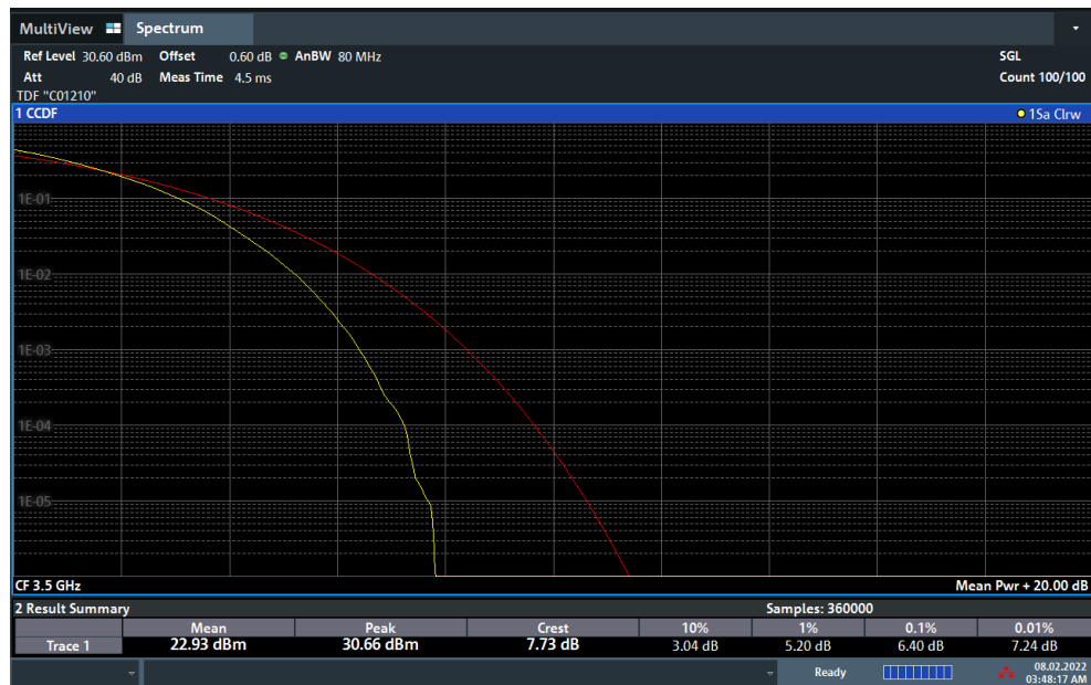
Plot 7-142. PAR Plot (NR Band n77 - 80MHz DFT-s-OFDM 64-QAM - Full RB)
