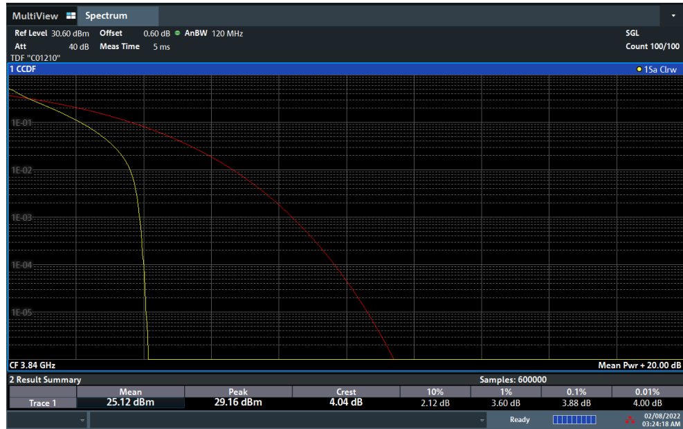
Plot 7-194. PAR Plot (NR Band n77 - 100MHz DFT-s-OFDM \pi/2 BPSK - Full RB)
