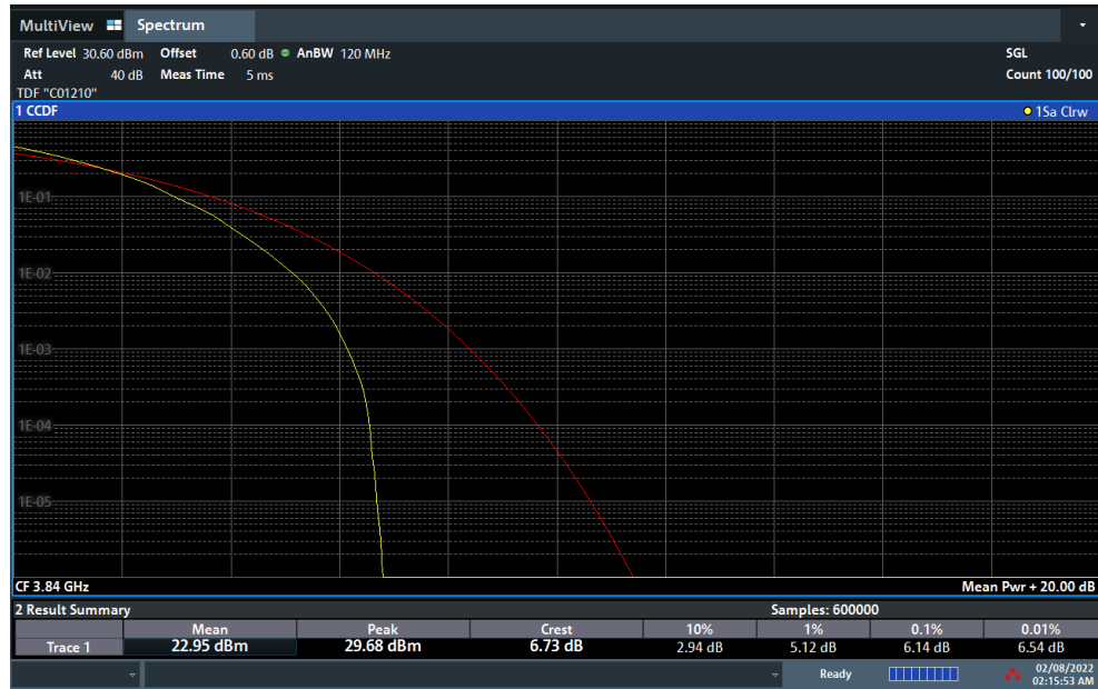
Plot 7-192. PAR Plot (NR Band n77 - 90MHz DFT-s-OFDM 64-QAM - Full RB)
