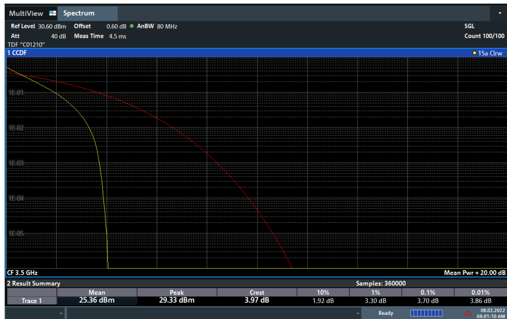
Plot 7-124. PAR Plot (NR Band n77 - 50MHz DFT-s-OFDM \pi/2 BPSK - Full RB)
