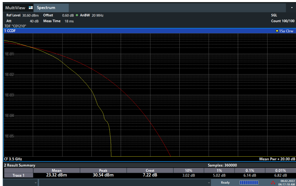
Plot 7-112. PAR Plot (NR Band n77 - 20MHz DFT-s-OFDM 64-QAM - Full RB)
