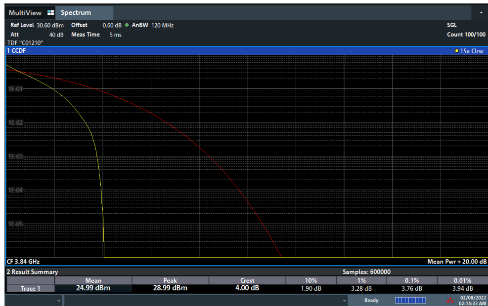
Plot 7-189. PAR Plot (NR Band n77 - 90MHz DFT-s-OFDM \pi/2 BPSK - Full RB)
