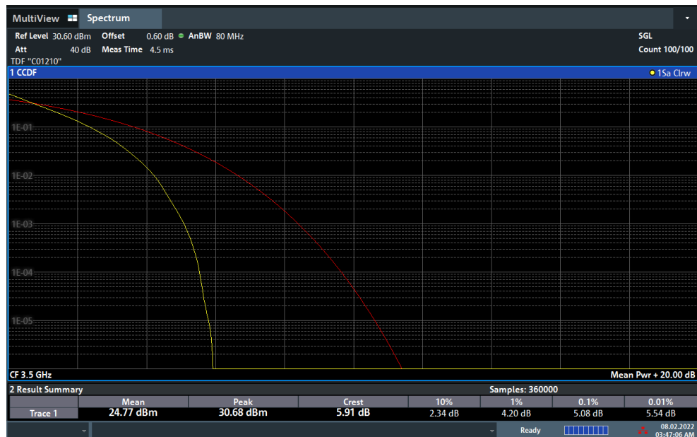
Plot 7-140. PAR Plot (NR Band n77 - 80MHz DFT-s-OFDM QPSK - Full RB)
