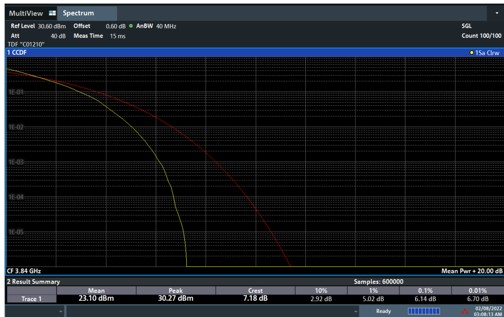
Plot 7-167. PAR Plot (NR Band n77 - 40MHz DFT-s-OFDM 64-QAM - Full RB)
