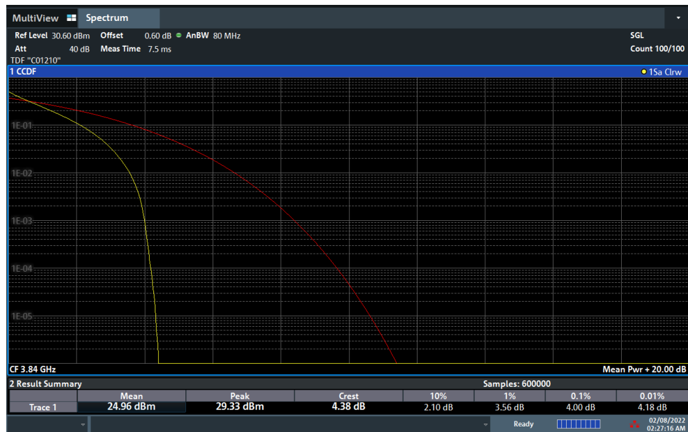
Plot 7-179. PAR Plot (NR Band n77 - 70MHz DFT-s-OFDM \pi/2 BPSK - Full RB)
