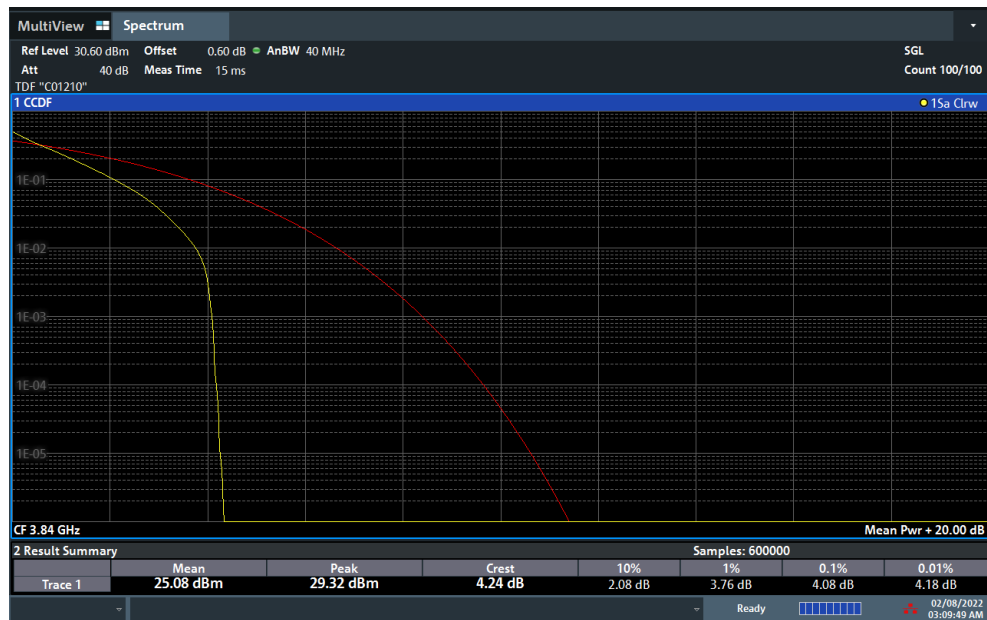
Plot 7-159. PAR Plot (NR Band n77 - 30MHz DFT-s-OFDM \pi/2 BPSK - Full RB)
