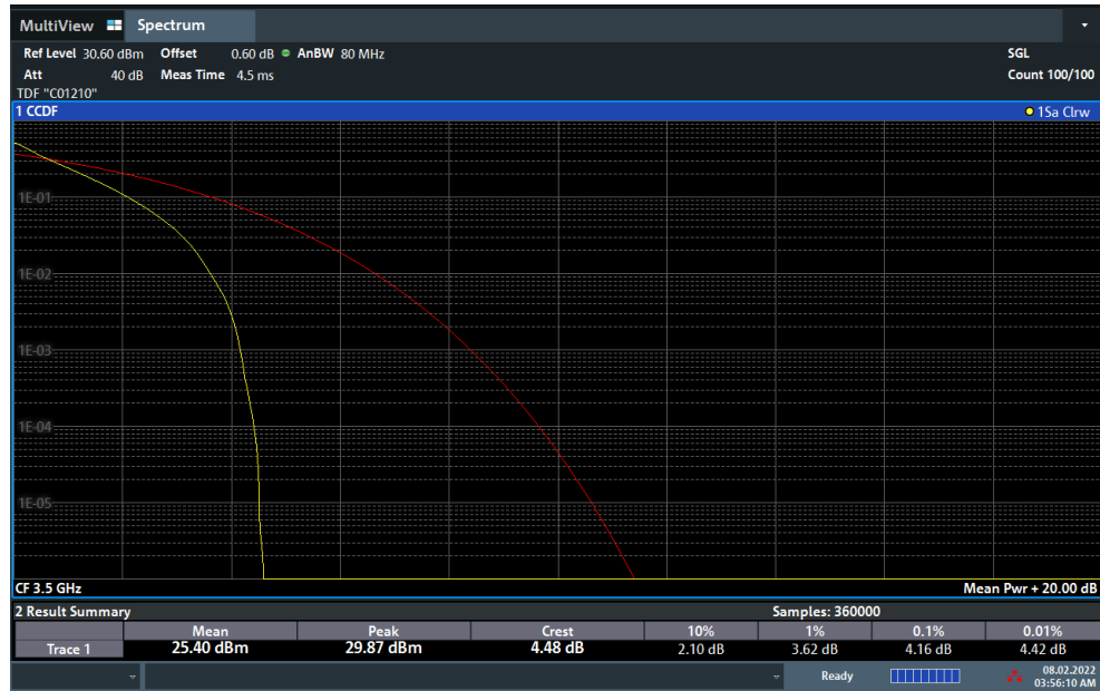
Plot 7-129. PAR Plot (NR Band n77 - 60MHz DFT-s-OFDM \pi/2 BPSK - Full RB)
