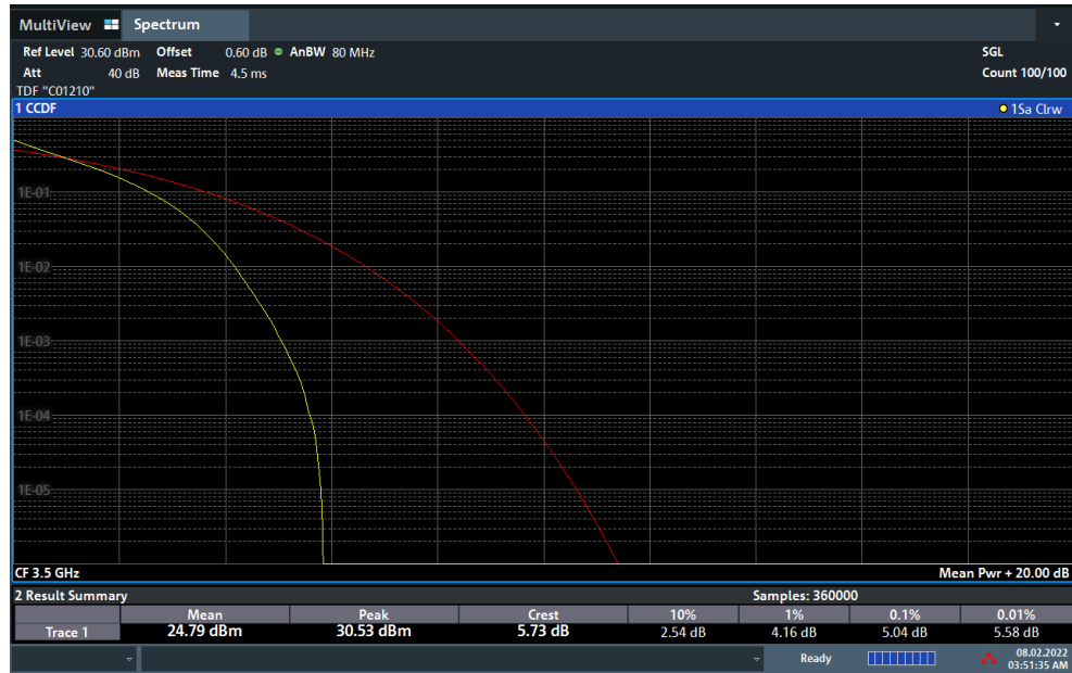
Plot 7-135. PAR Plot (NR Band n77 - 70MHz DFT-s-OFDM QPSK - Full RB)
