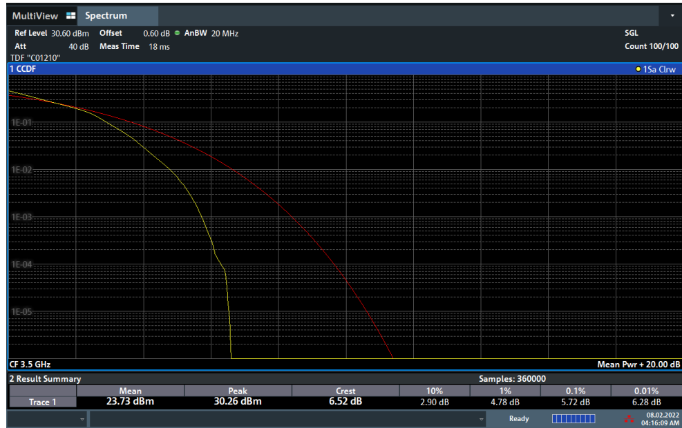
Plot 7-111. PAR Plot (NR Band n77 - 20MHz DFT-s-OFDM 16-QAM - Full RB)
