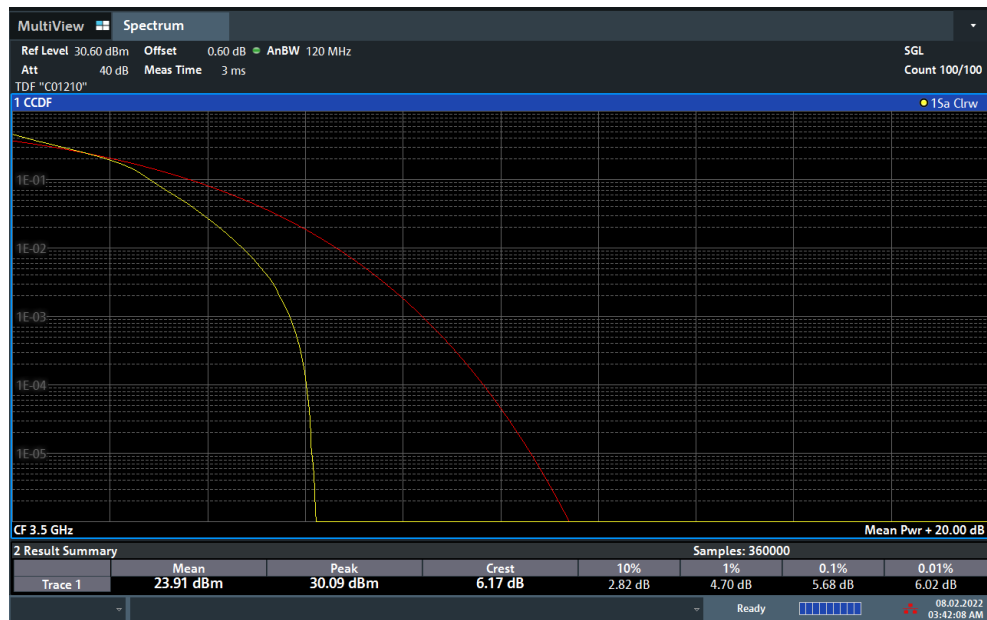
Plot 7-146. PAR Plot (NR Band n77 - 90MHz DFT-s-OFDM 16-QAM - Full RB)
