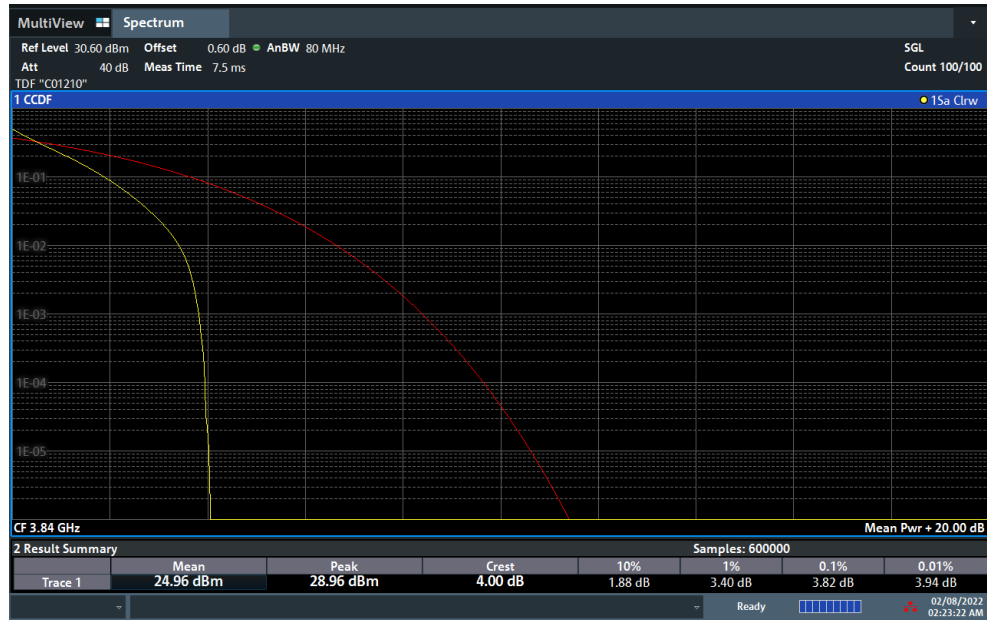
Plot 7-184. PAR Plot (NR Band n77 - 80MHz DFT-s-OFDM \pi/2 BPSK - Full RB)
