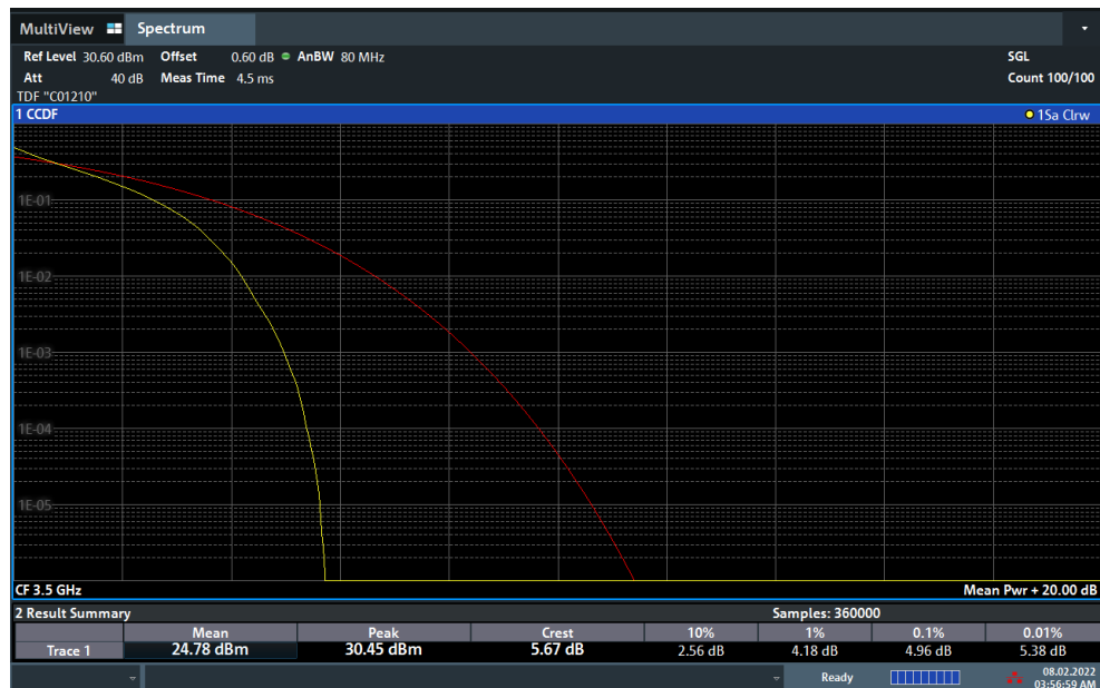
Plot 7-130. PAR Plot (NR Band n77 - 60MHz DFT-s-OFDM QPSK - Full RB)
