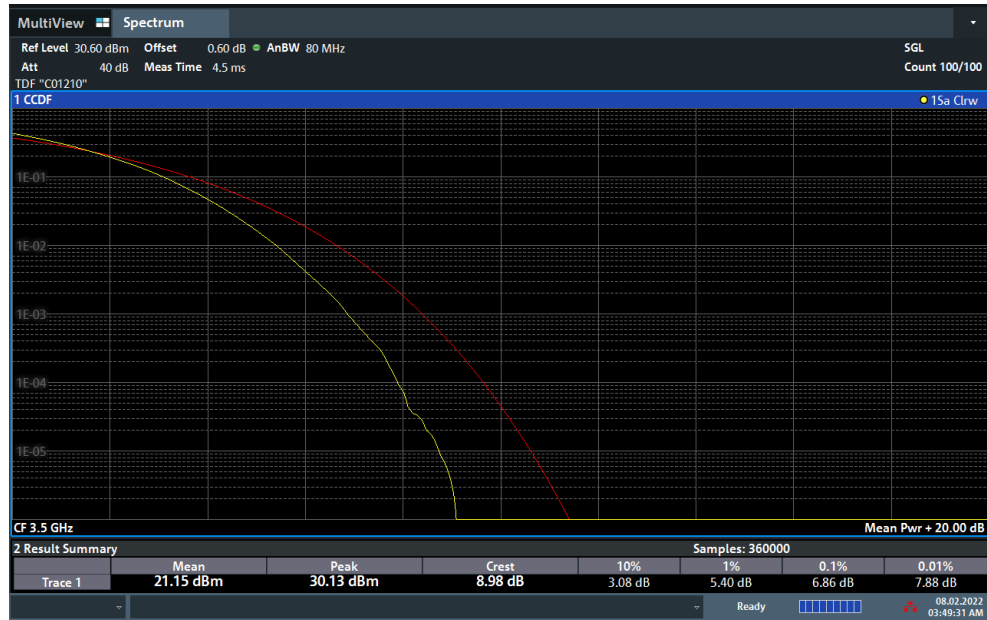
Plot 7-143. PAR Plot (NR Band n77 - 80MHz DFT-s-OFDM 256-QAM - Full RB)
