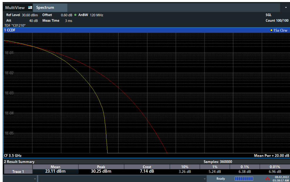
Plot 7-152. PAR Plot (NR Band n77 - 100MHz DFT-s-OFDM 64-QAM - Full RB)
