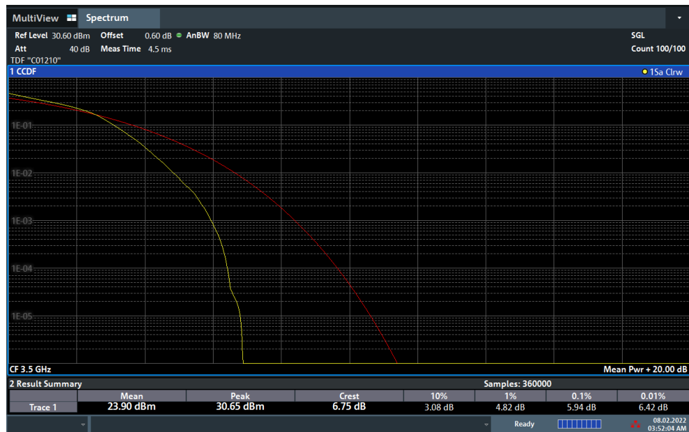
Plot 7-136. PAR Plot (NR Band n77 - 70MHz DFT-s-OFDM 16-QAM - Full RB)
