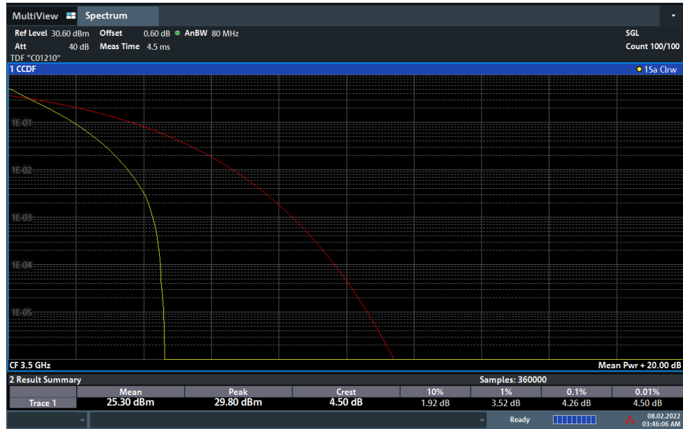
Plot 7-139. PAR Plot (NR Band n77 - 80MHz DFT-s-OFDM \pi/2 BPSK - Full RB)
