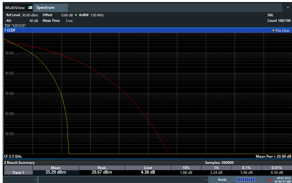
Plot 7-144. PAR Plot (NR Band n77 - 90MHz DFT-s-OFDM \pi/2 BPSK - Full RB)
