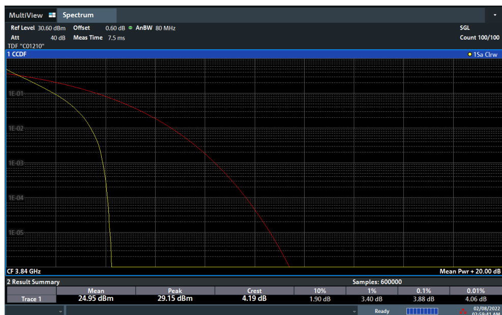
Plot 7-169. PAR Plot (NR Band n77 - 50MHz DFT-s-OFDM \pi/2 BPSK - Full RB)
