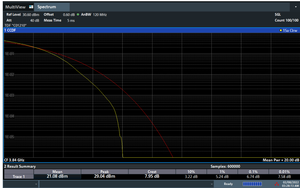
Plot 7-198. PAR Plot (NR Band n77 - 100MHz DFT-s-OFDM 256-QAM - Full RB)
