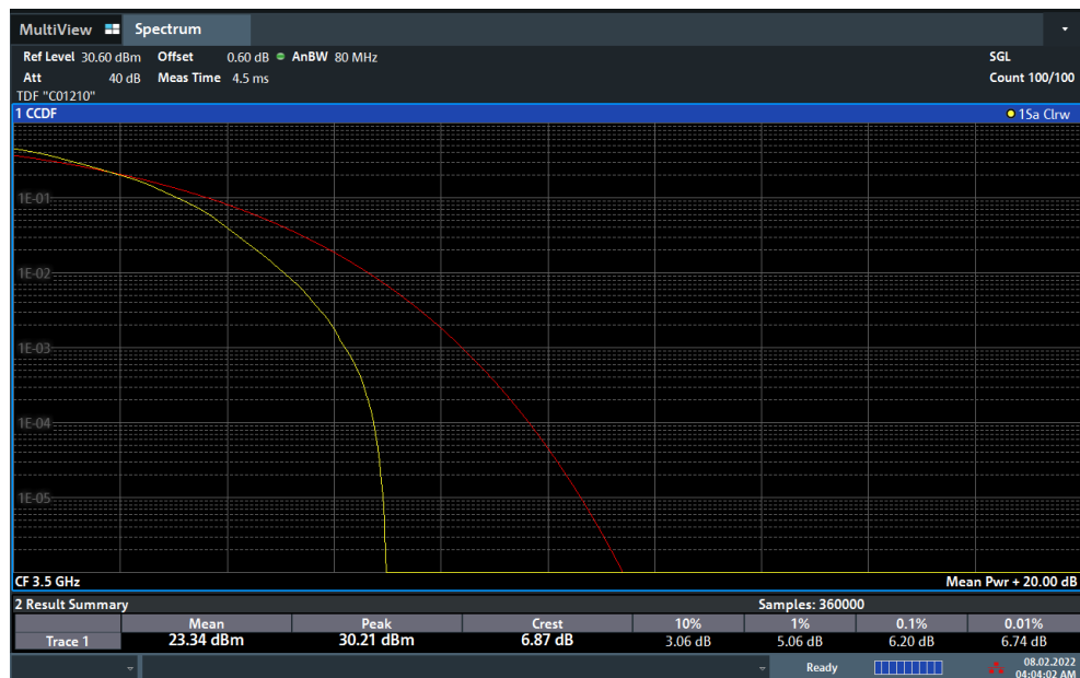
Plot 7-127. PAR Plot (NR Band n77 - 50MHz DFT-s-OFDM 64-QAM - Full RB)
