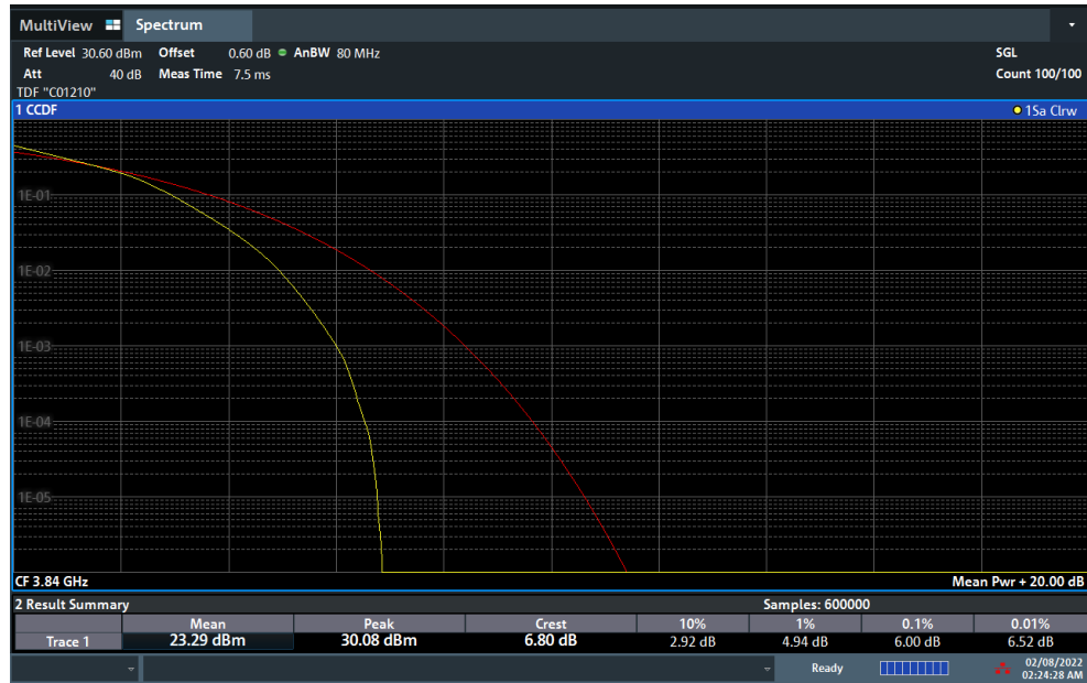
Plot 7-186. PAR Plot (NR Band n77 - 80MHz DFT-s-OFDM 16-QAM - Full RB)
