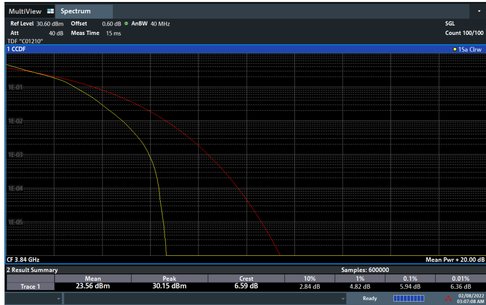
Plot 7-166. PAR Plot (NR Band n77 - 40MHz DFT-s-OFDM 16-QAM - Full RB)
