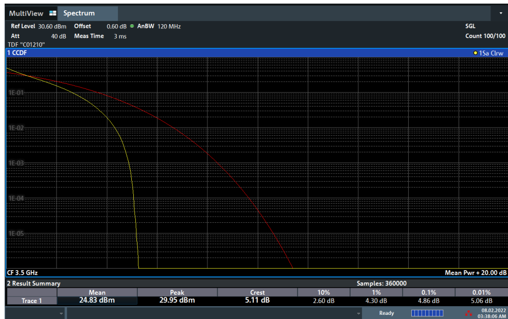
Plot 7-150. PAR Plot (NR Band n77 - 100MHz DFT-s-OFDM QPSK - Full RB)
