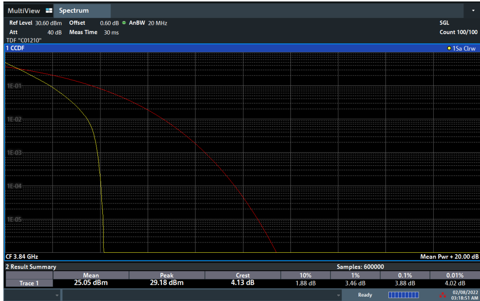
Plot 7-154. PAR Plot (NR Band n77 - 20MHz DFT-s-OFDM \pi/2 BPSK - Full RB)
