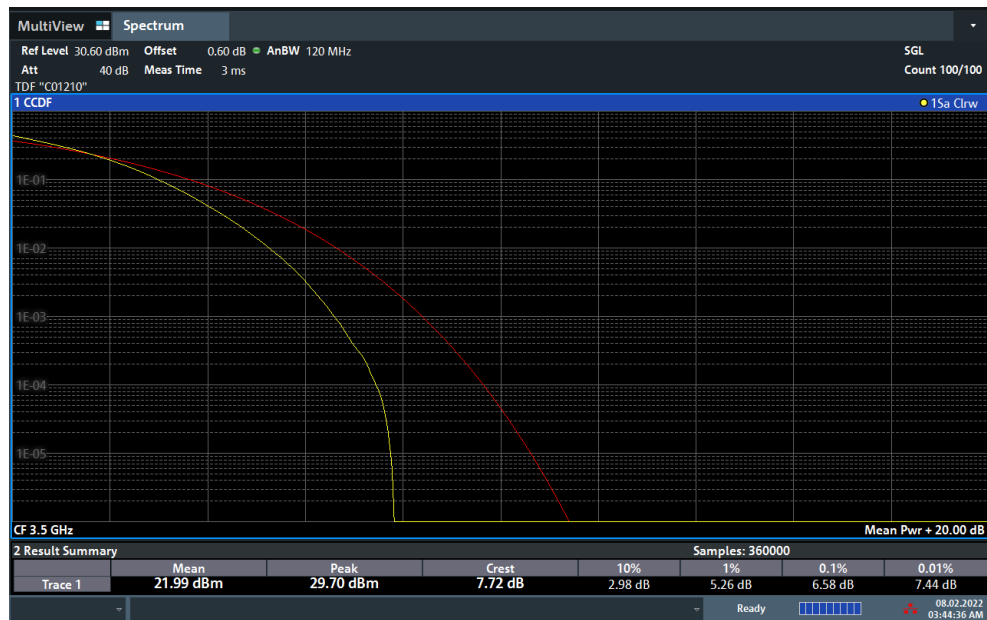
Plot 7-148. PAR Plot (NR Band n77 - 90MHz DFT-s-OFDM 256-QAM - Full RB)
