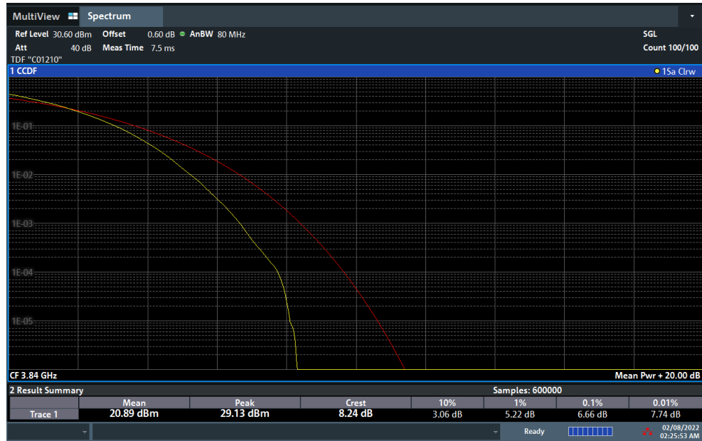
Plot 7-188. PAR Plot (NR Band n77 - 80MHz DFT-s-OFDM 256-QAM - Full RB)
