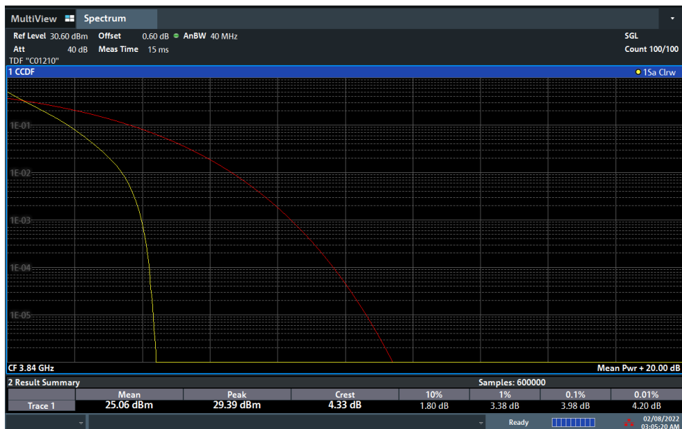
Plot 7-164. PAR Plot (NR Band n77 - 40MHz DFT-s-OFDM \pi/2 BPSK - Full RB)
