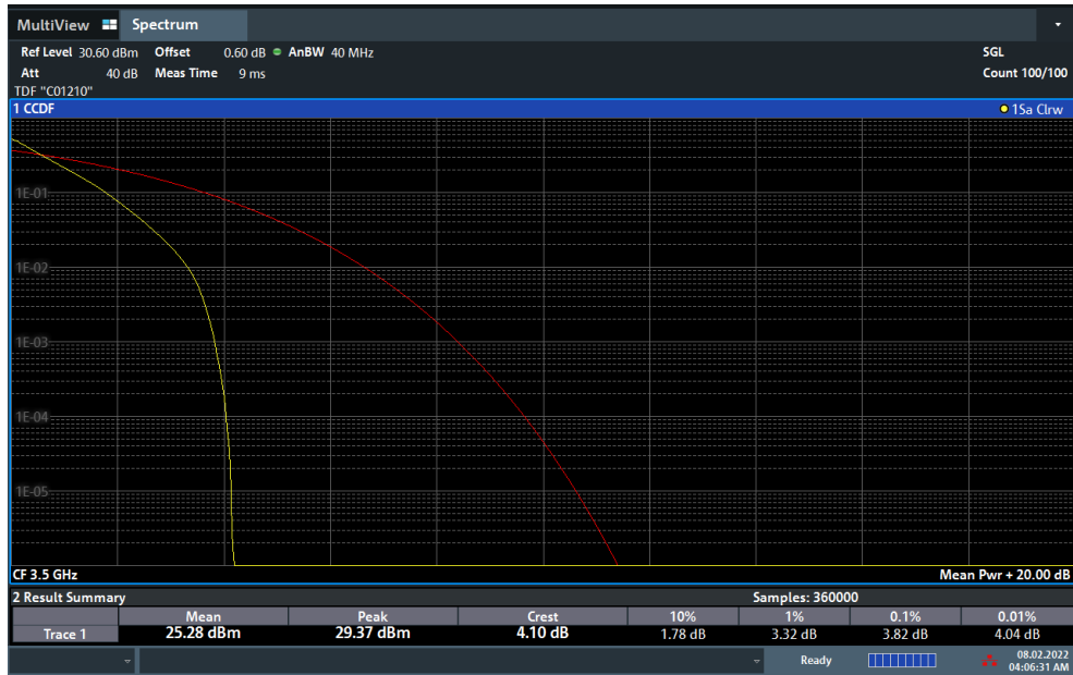
Plot 7-119. PAR Plot (NR Band n77 - 40MHz DFT-s-OFDM \pi/2 BPSK - Full RB)
