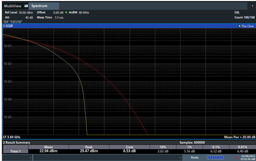
Plot 7-172. PAR Plot (NR Band n77 - 50MHz DFT-s-OFDM 64-QAM - Full RB)
