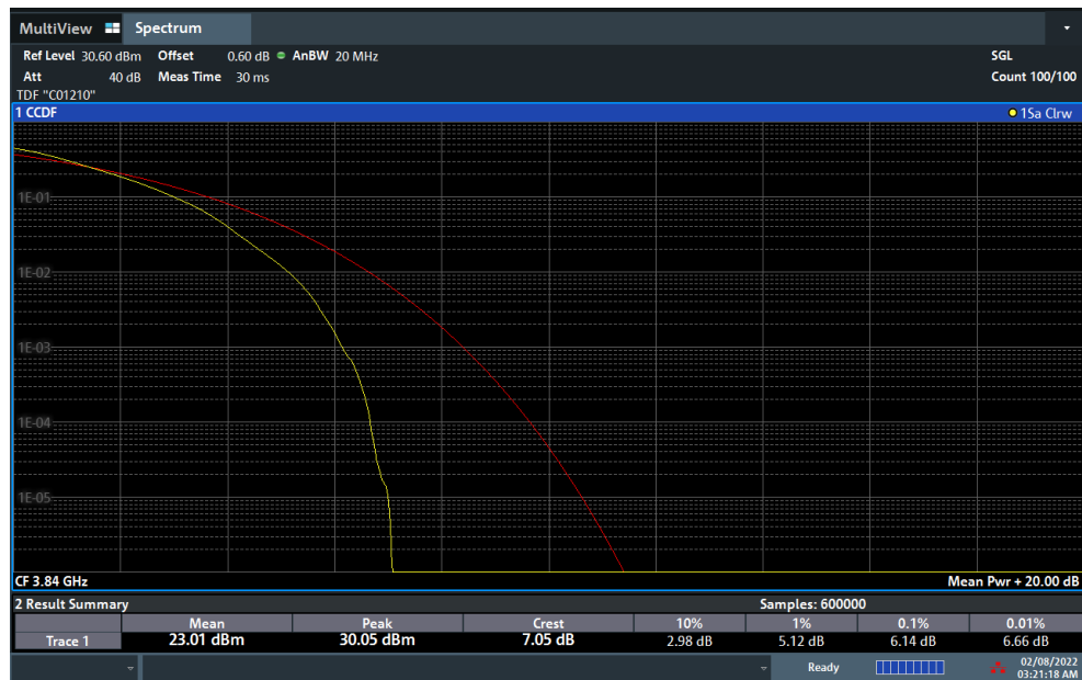
Plot 7-157. PAR Plot (NR Band n77 - 20MHz DFT-s-OFDM 64-QAM - Full RB)
