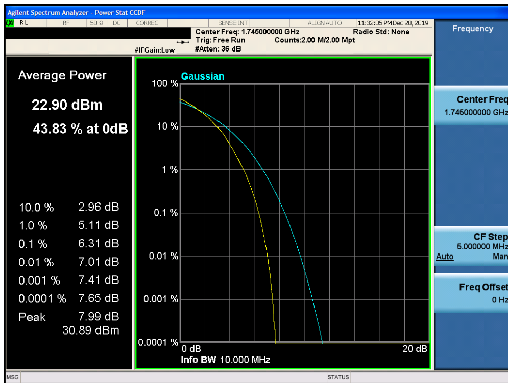
Plot 7-354. PAR Plot (Band 66 - 10.0MHz 64-QAM - RB Size 50)
