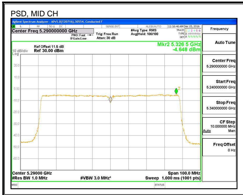
**8.23. 802.11ac VHT80 2Tx (ANTENNA A + ANTENNA B) CDD MODE IN THE 5.3 GHz BAND**
