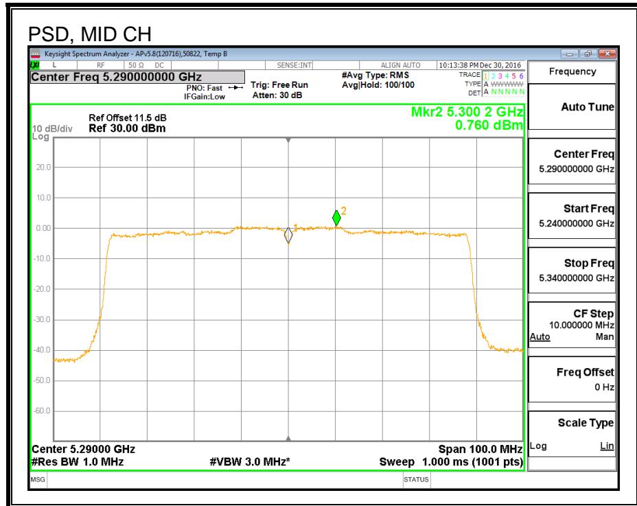
**8.24. 802.11ac VHT80 2Tx (ANTENNA A + ANTENNA B) STBC MODE IN
