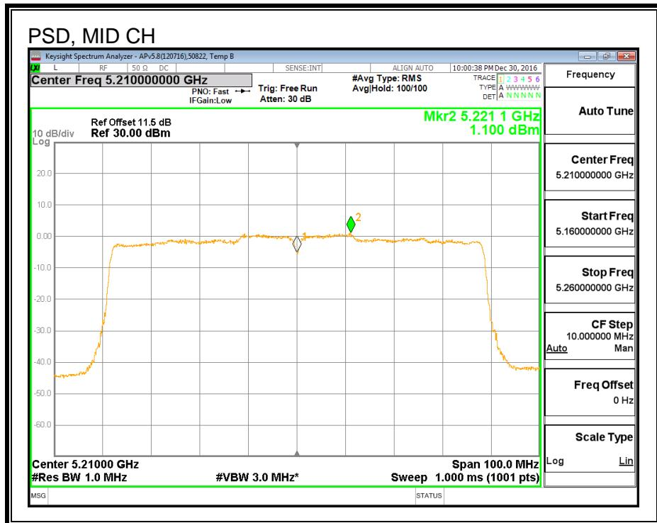
**8.12. 802.11ac VHT80 2Tx (ANTENNA A + ANTENNA B) STBC MODE IN
