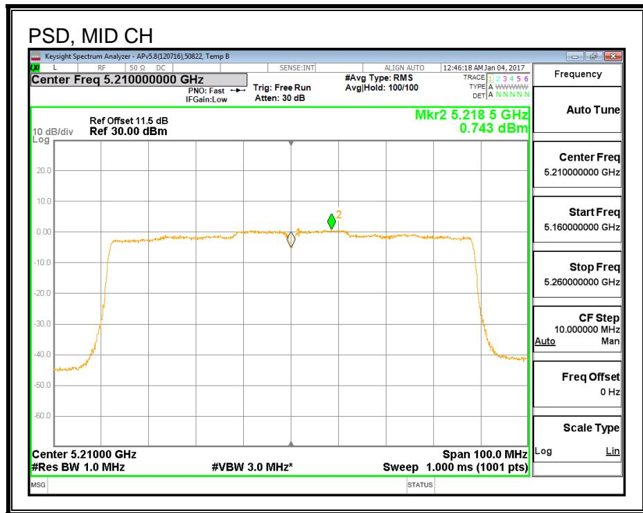
**8.11. 802.11ac VHT80 2Tx (ANTENNA A + ANTENNA B) CDD MODE IN
