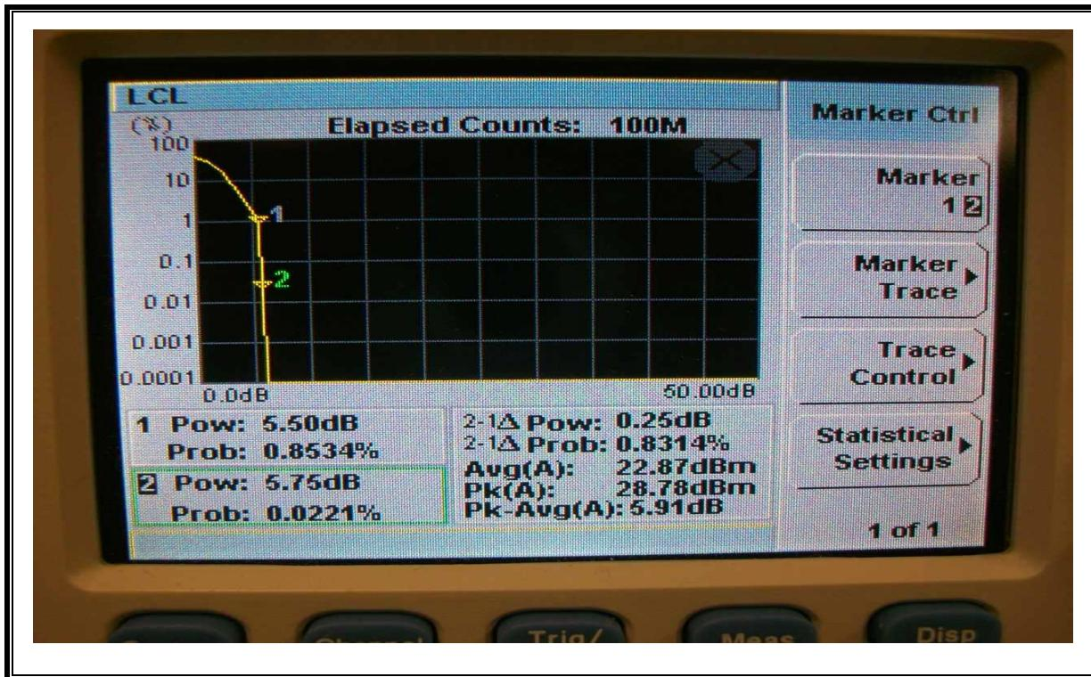
LTE QPSK Band 2 (5.0 MHz BAND WIDTH)
