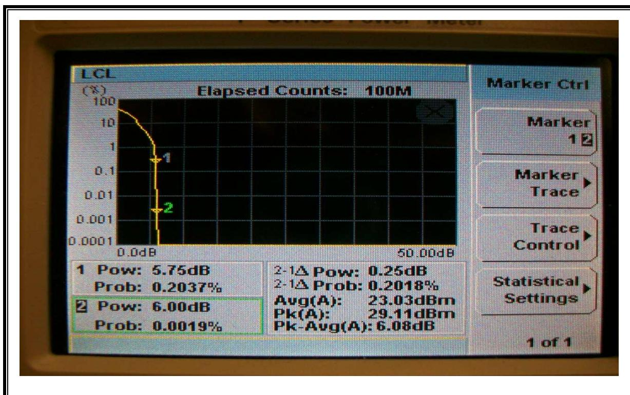
LTE QPSK Band 2 (3.0 MHz BAND WIDTH)
