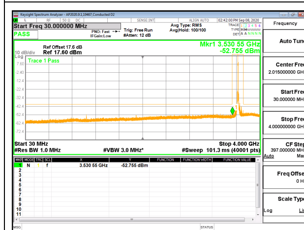
LTE B48 20MHz + 20MHz QPSK Mid Ch RB1-99 + RB1-0 30MHz-4GHz
