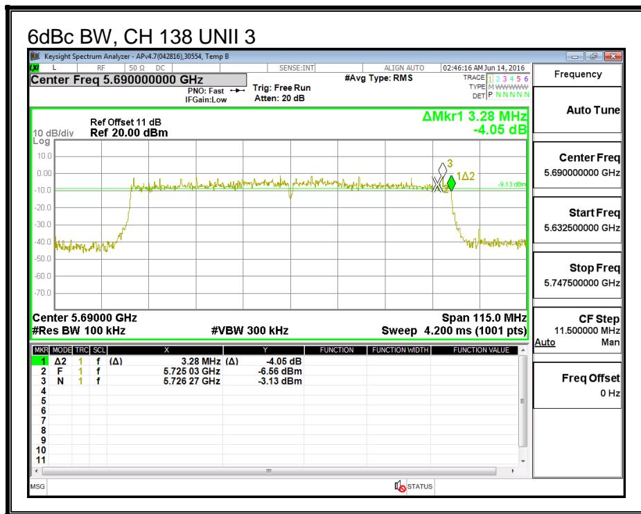
**7.46. 802.11ac VHT80 2Tx STBC MODE IN THE 5.6 GHz BAND
