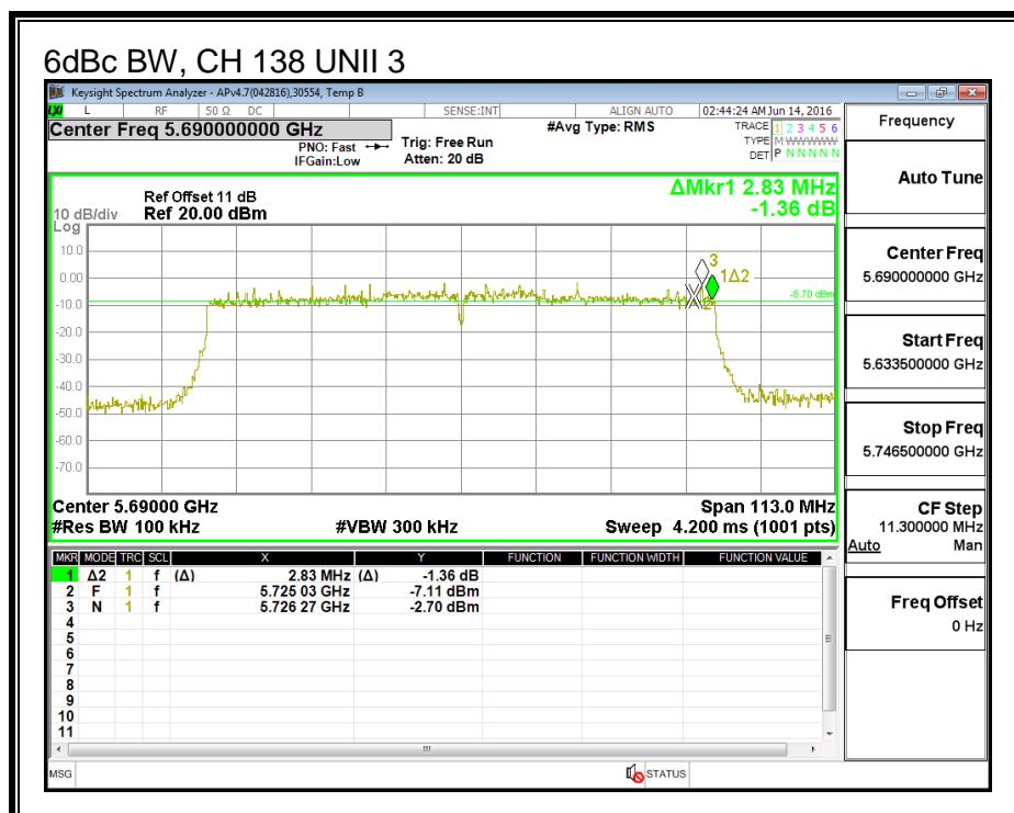
**7.45. 802.11ac VHT80 2Tx CDD MODE IN THE 5.6 GHz BAND
