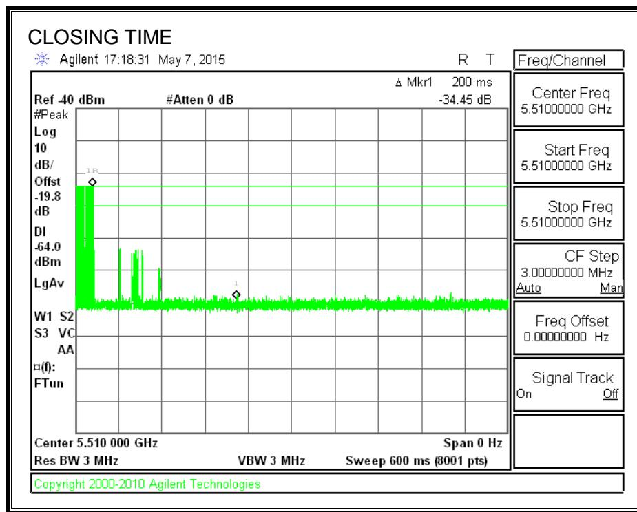
**AGGREGATE CHANNEL CLOSING TRANSMISSION TIME**
