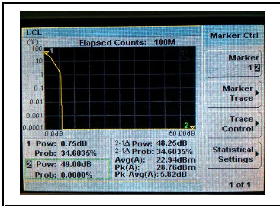
**QPSK Band 25 (15 MHz BAND WIDTH)**
