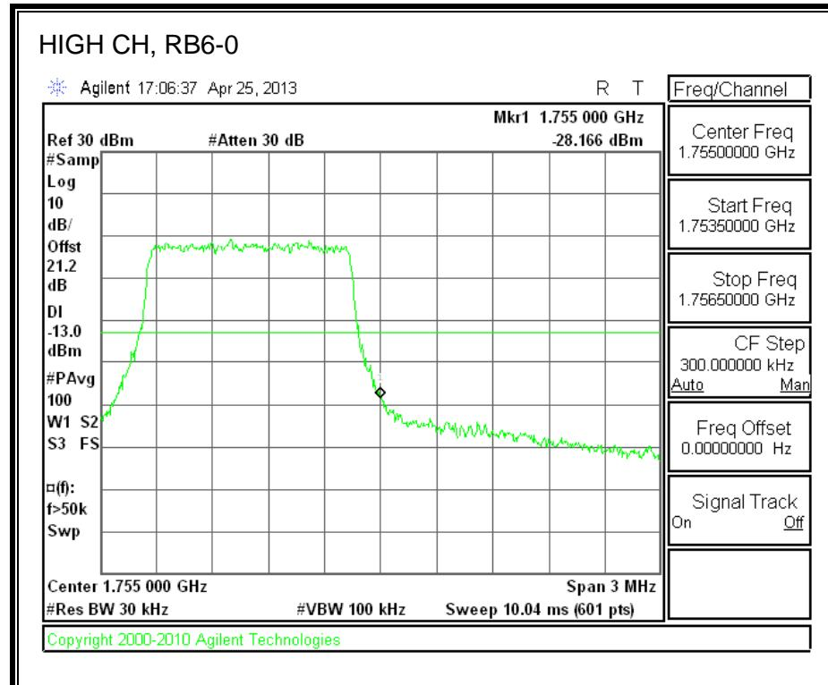
**LTE QPSK Band 4 (3.0 MHz BAND WIDTH)**
