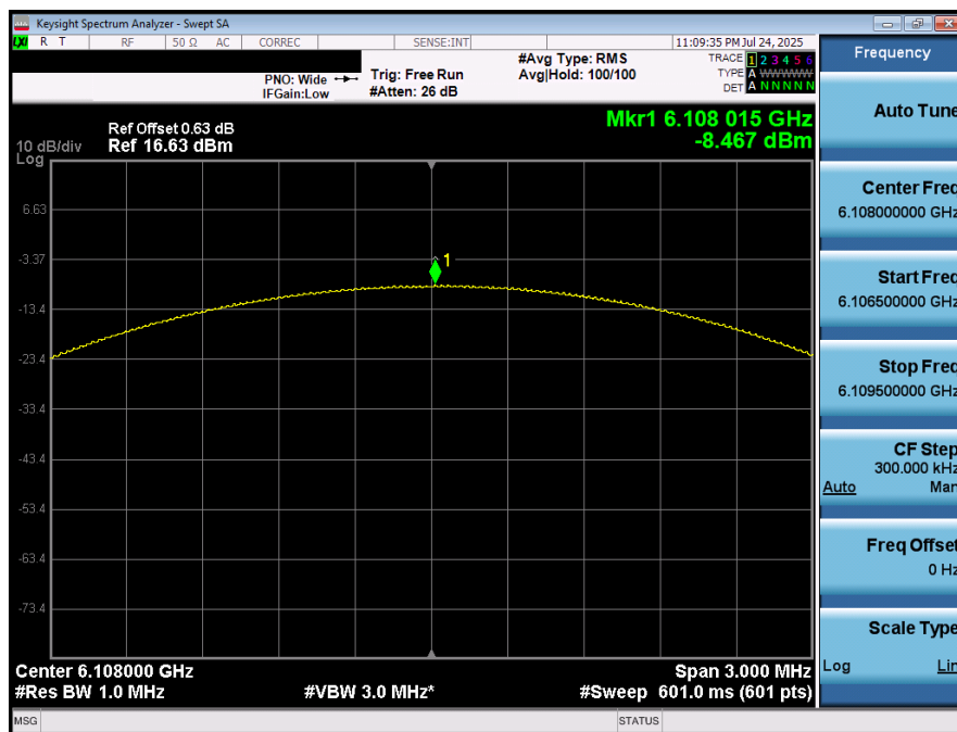
Plot 7-28. PSD (NB UNII LE2M - 6108MHz)
