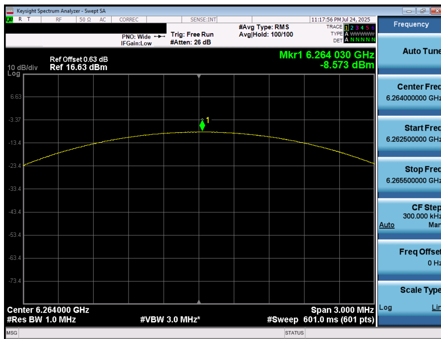
Plot 7-29. PSD (NB UNII LE2M - 6264MHz)
