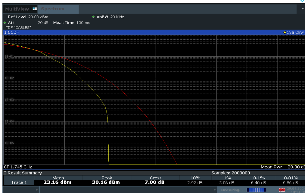
Plot 7-150. PAR Plot (LTE Band 66 - 20MHz 16-QAM - Full RB)
