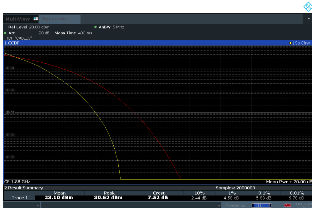
Plot 7-106. PAR Plot (LTE Band 2 - 5MHz QPSK - Full RB Configuration)
