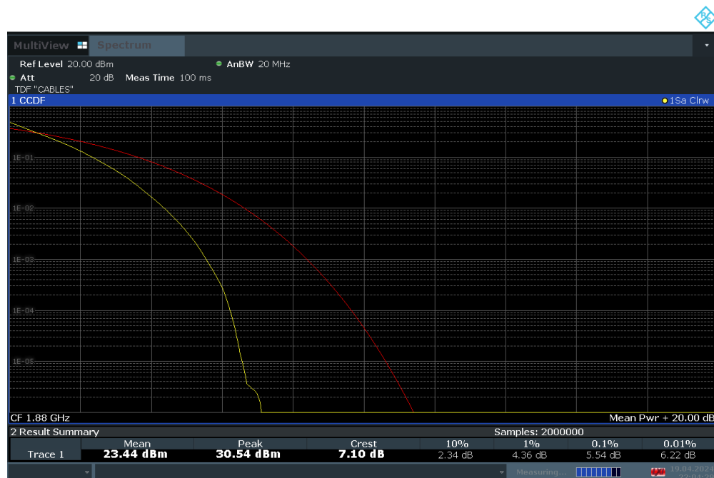
Plot 7-112. PAR Plot (LTE Band 2 - 20MHz QPSK - Full RB Configuration)
