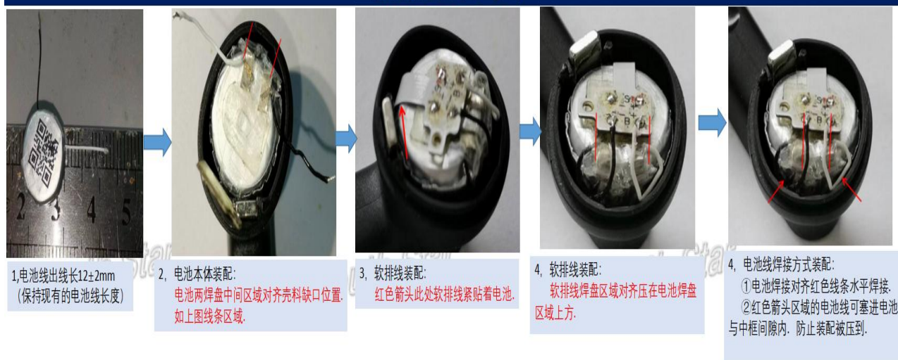
电池线装配示意图 ( Right )
