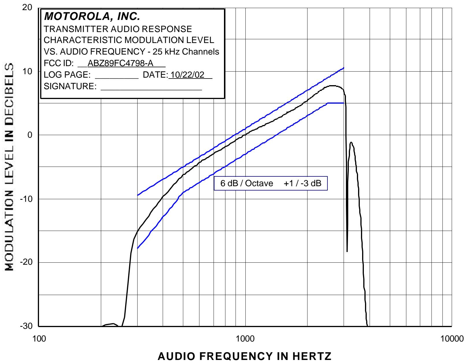
**MODULATION LIMITING - MODULATION CHARACTERISTICS****SPECIFICATION REQUIREMENT:**
