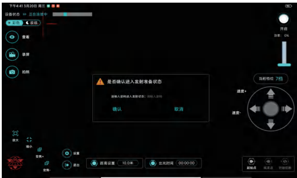
图15. 长按出光按钮可以进入确认页面 输入密码进入发射准备状态（根据用户需求配置）
