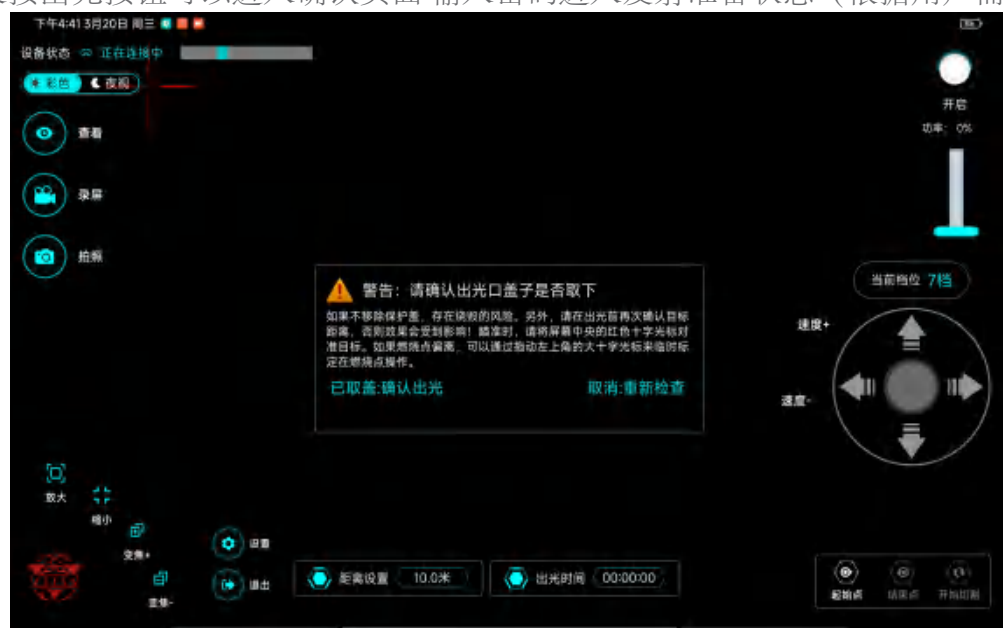
图16. 再次确认进入发射状态 进入发射状态后 出光时间会开始计时
