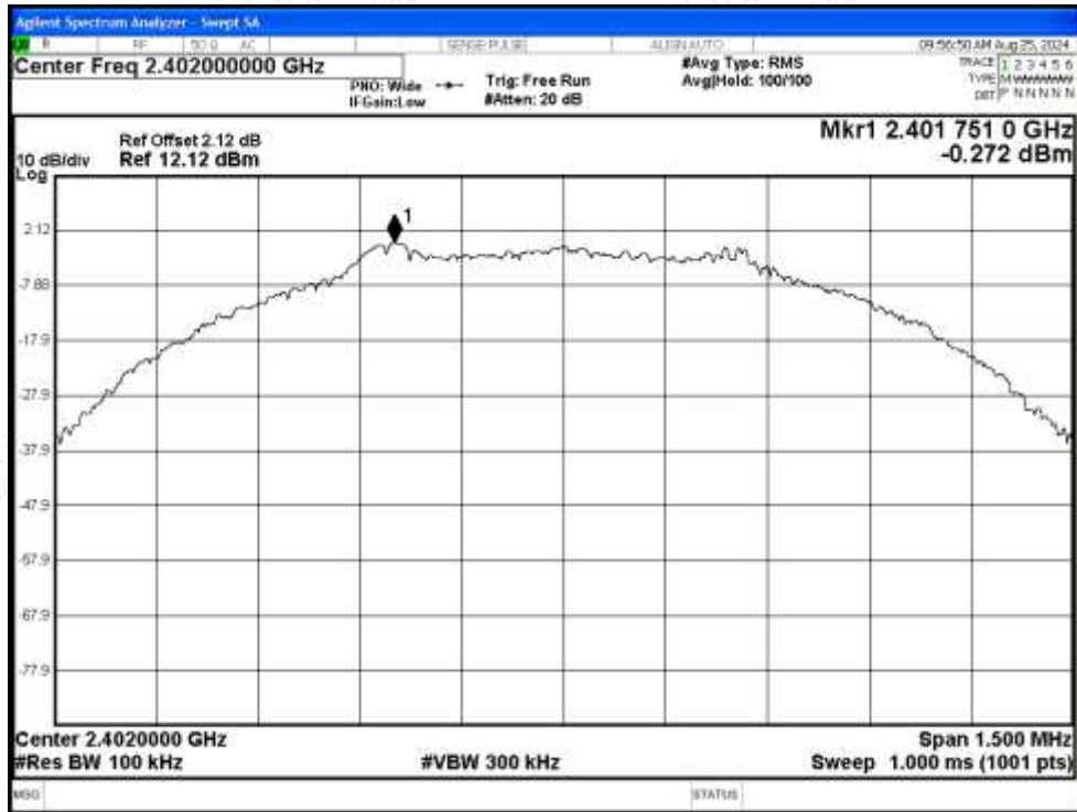
Tx. Spurious NVNT BLE 2402MHz Ant Emission
