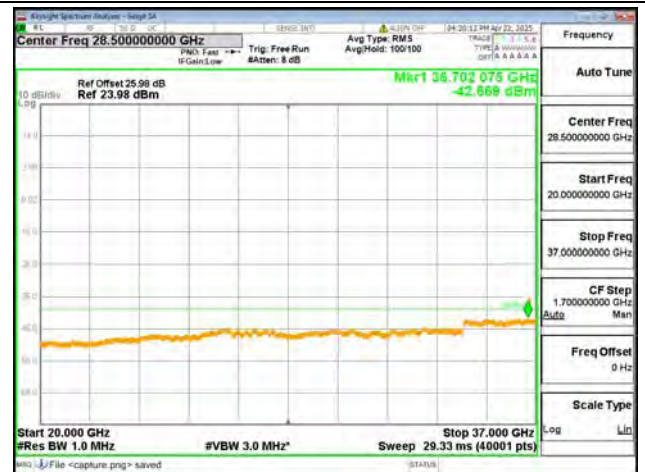
B48-20G-37G / 10MHz / Mid CH / QPSK
