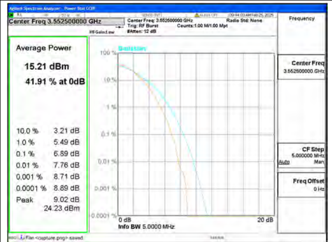
B48 / 5MHz / Low CH / 256QAM
