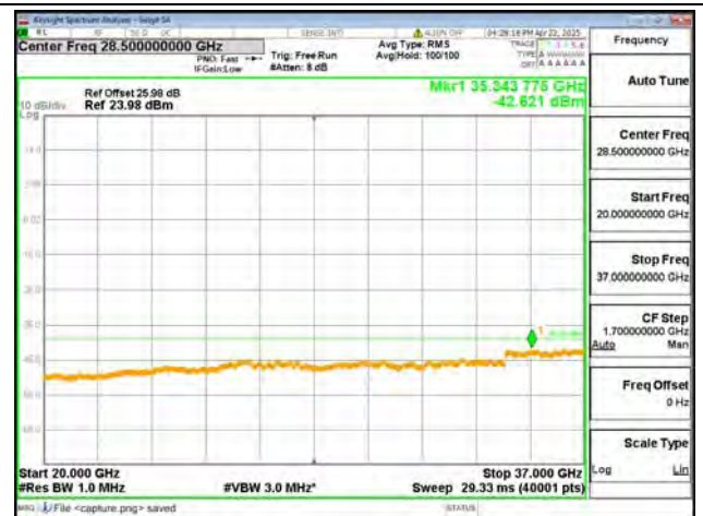
B48-20G-37G / 20MHz / High CH / QPSK
