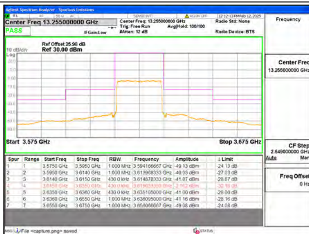
B48 / 20MHz / Mid CH / QPSK / FULL RB
