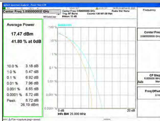
B48 / 20MHz / High CH / 64QAM
