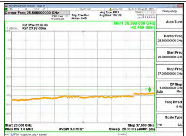
B48-20G-37G / 10MHz / High CH / QPSK
