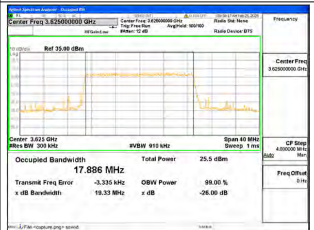
B48 / 20MHz / 16QAM/ Mid CH
