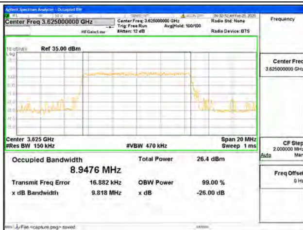
B48 / 10MHz / QPSK/ Mid CH
