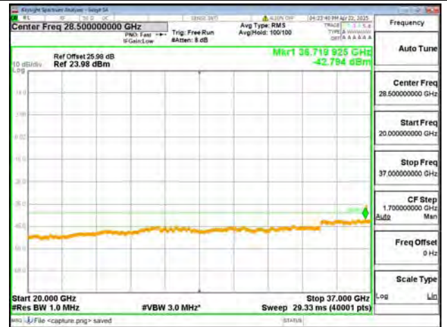
B48-20G-37G / 15MHz / Mid CH / QPSK
