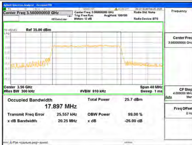
B48 / 20MHz / 64QAM/ Low CH
