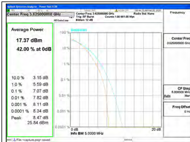
B48 / 5MHz / Mid CH / 64QAM
