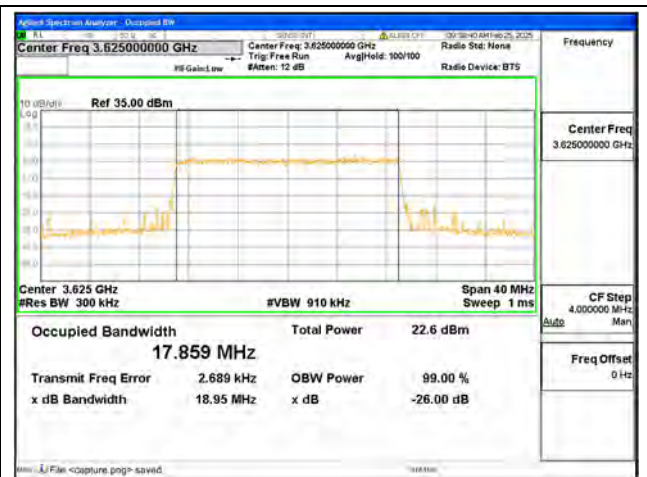
B48 / 20MHz / 256QAM/ Mid CH
