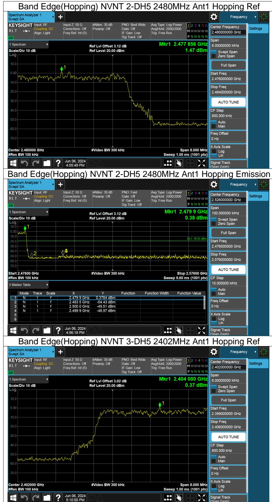
**Band Edge(Hopping) NVNT 3-DH5 2402MHz Ant1 Hopping Emission**
