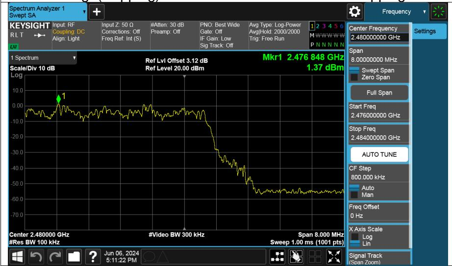
**Band Edge(Hopping) NVNT 3-DH5 2480MHz Ant1 Hopping Emission**
