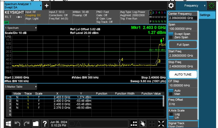
**Band Edge(Hopping) NVNT 3-DH5 2480MHz Ant1 Hopping Ref**
