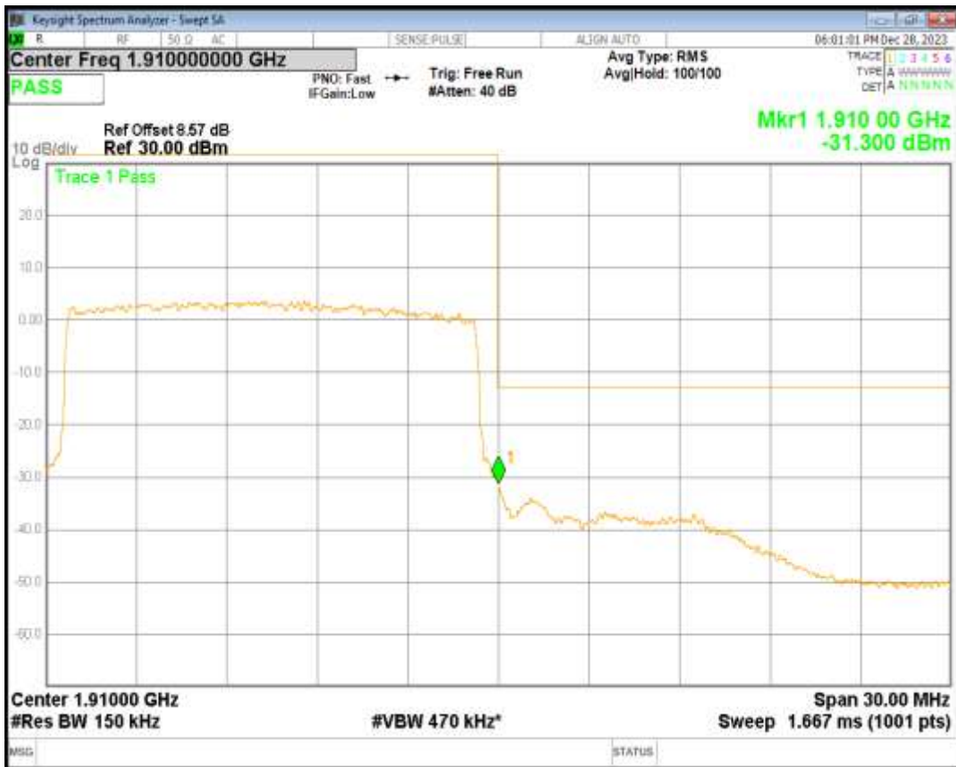
Band2 QPSK BW=20MHz Channel=18700 RB Size=100 Position=#0
