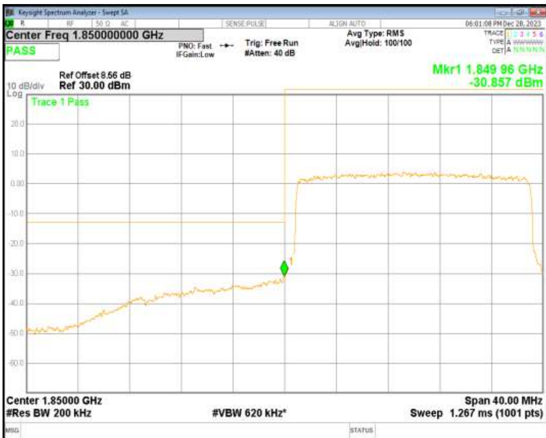
Band2 QPSK BW=20MHz Channel=19100 RB Size=100 Position=#0
