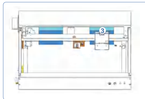
将X轴向前移动，然后取出气泡棉③
