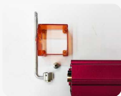
Retire la cubierta protectora, la cubierta de la guía de aire, la boquilla y el espejo de la ventana.
