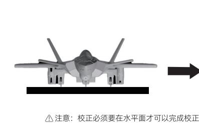
△ 注意: 校正必须要在水平面才可以完成校正。
