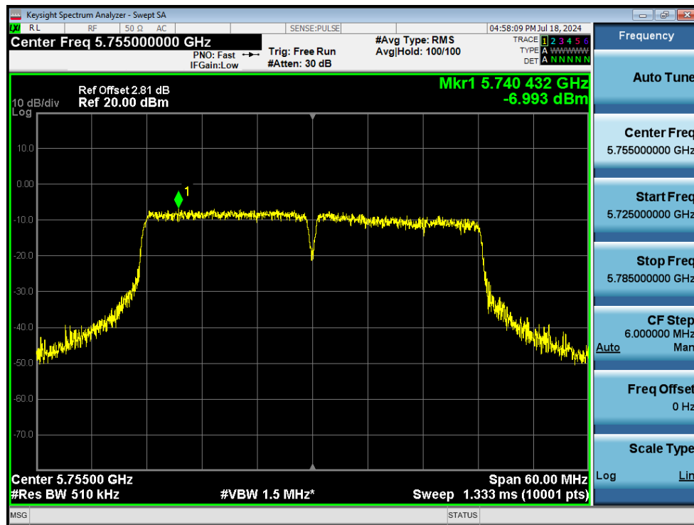
PSD NVNT n40 5755MHz Ant1
