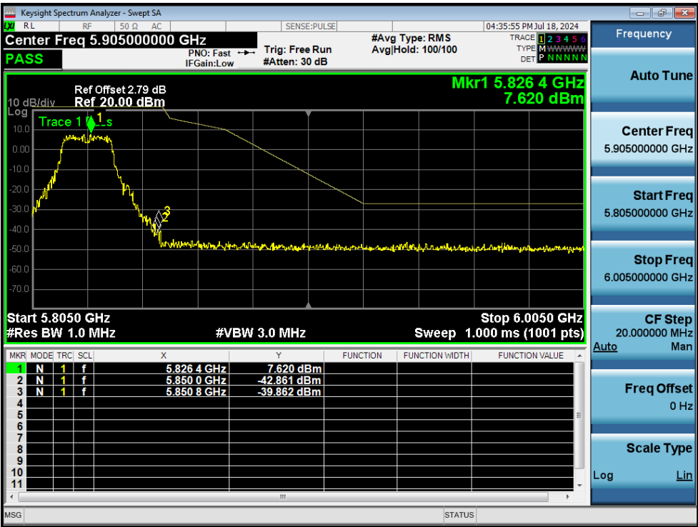
Band Edge NVNT ac20 5825MHz High Ant1
