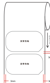
走纸示意图: 跳距: 3mm 边距: 3mm
