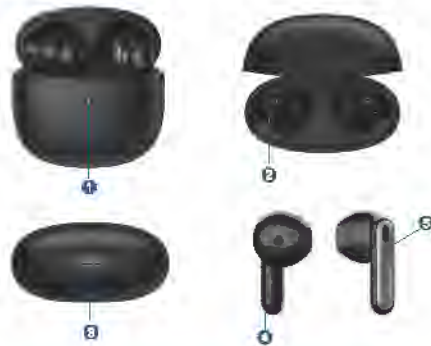
①指示灯 ②充电顶针 ③Type-c充电口 ④充电触点 ⑤触控区域
