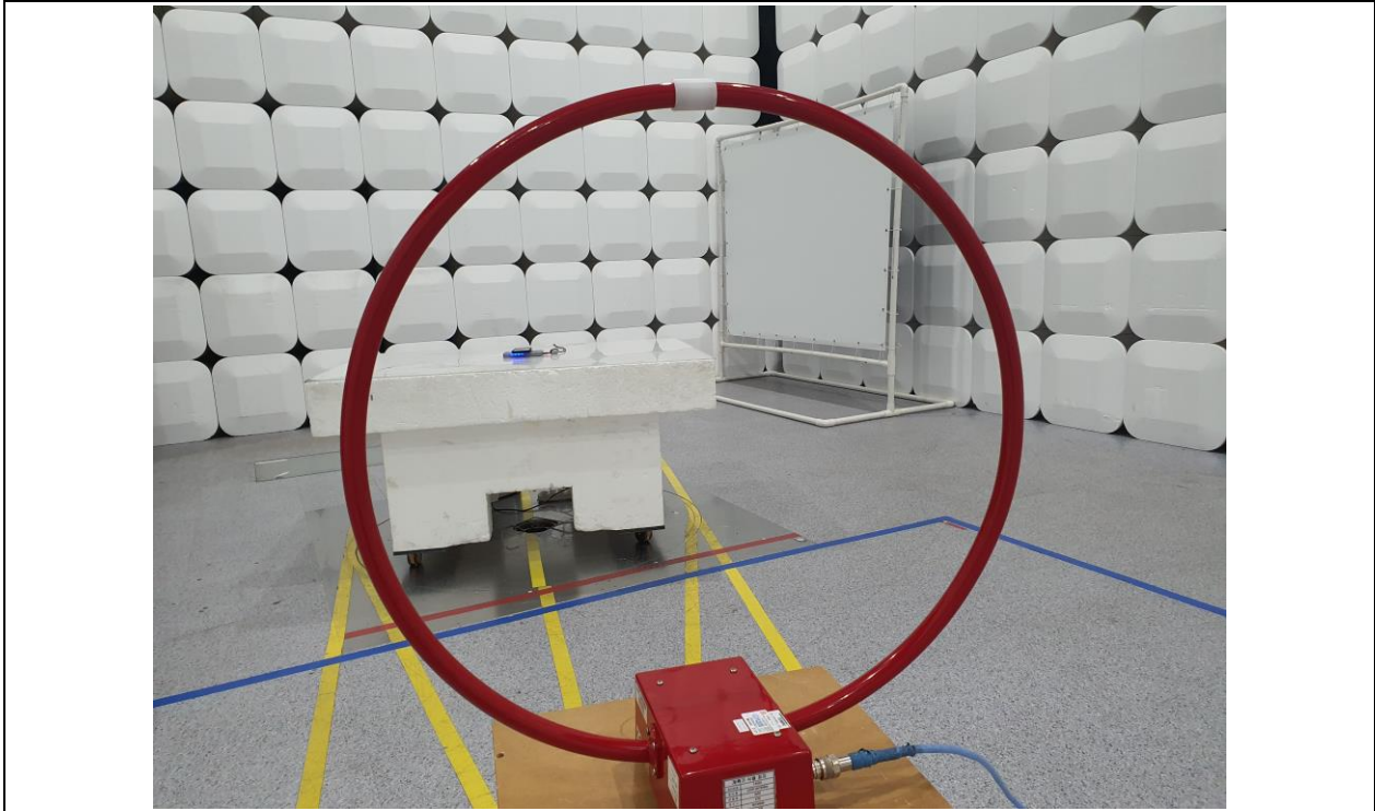
Test distance : 3 m, height of table : 0.8 m
