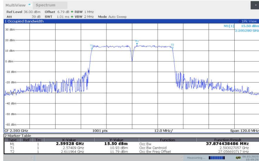
**LTE CA\_41C , 20MHz+20MHz Bandwidth,16QAM (99% OBW)**
