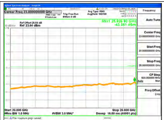
B7-20G-26G / 20MHz / Low CH / QPSK
