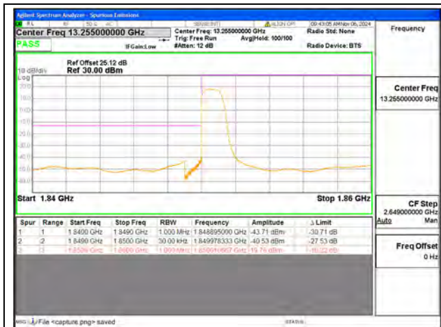
B2 / 10MHz / Low CH / QPSK / 1 RB
