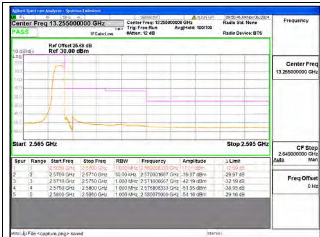
B7 / 10MHz / High CH / QPSK / 1 RB
