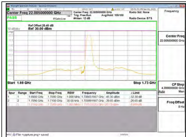
B4 / 20MHz / Low CH / QPSK / 1 RB
