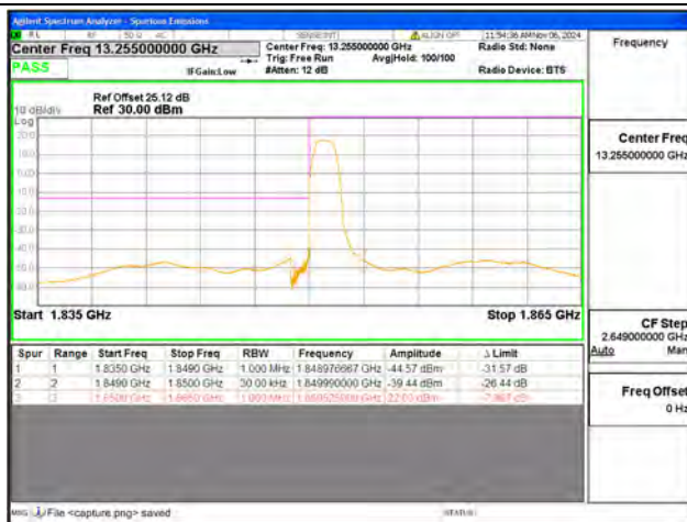
B25 / 15MHz / Low CH / QPSK / 1 RB
