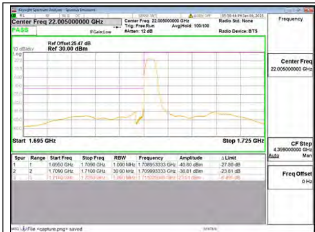
B4 / 15MHz / Low CH / QPSK / 1 RB
