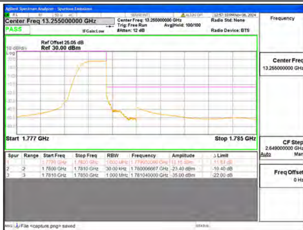
B66 / 1.4MHz / High CH / QPSK / 1 RB
