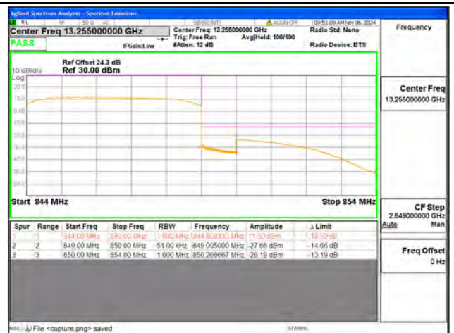
B5 / 5MHz / High CH / QPSK / FULL RB
