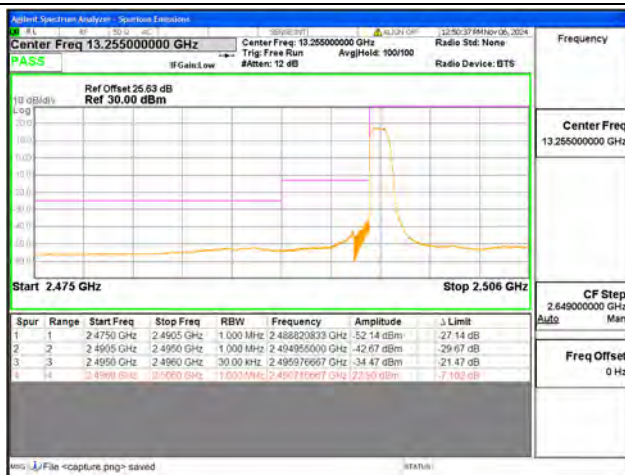
B41 / 10MHz / Low CH / QPSK / 1 RB
