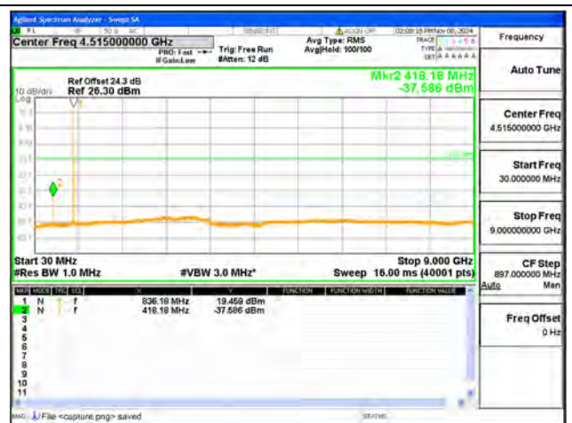
B26 / 1.4MHz / Mid CH / QPSK
