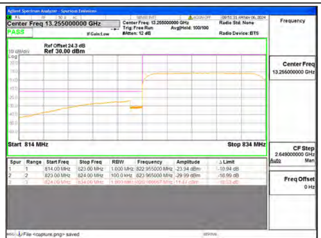
B5 / 10MHz / Low CH / QPSK / FULL RB
