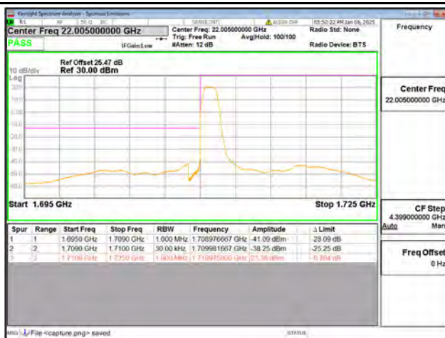
B4 / 15MHz / Low CH / QPSK / 1 RB
