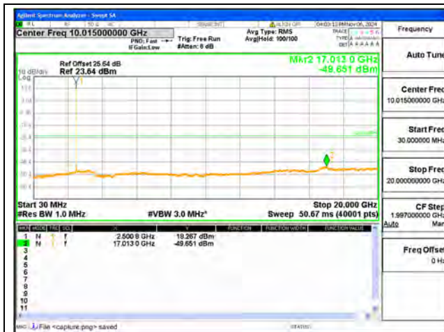
B7-30M-20G / 20MHz / Low CH / QPSK
