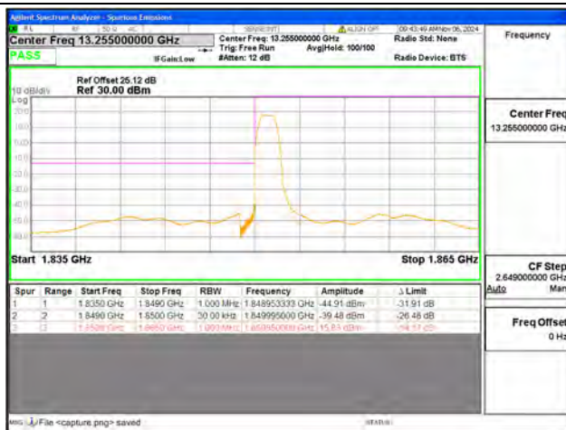
B2 / 15MHz / Low CH / QPSK / 1 RB
