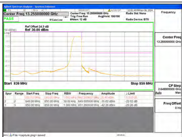
B26 / 10MHz / High CH / QPSK / 1 RB
