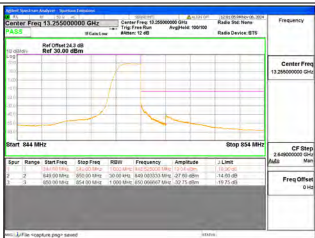
B26 / 5MHz / High CH / QPSK / 1 RB
