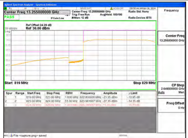
B5 / 5MHz / Low CH / QPSK / FULL RB
