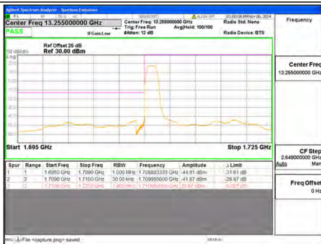
B66 / 15MHz / Low CH / QPSK / 1 RB
