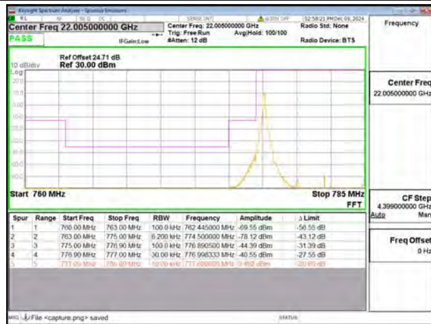
B13 / 10MHz / Low CH / QPSK / 1 RB
