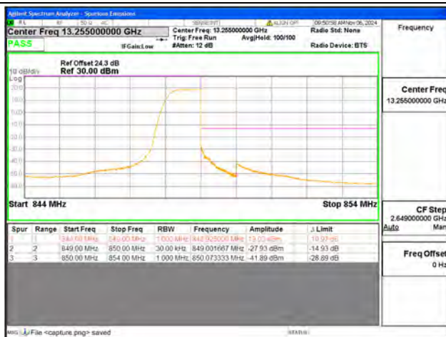
B5 / 5MHz / High CH / QPSK / 1 RB
