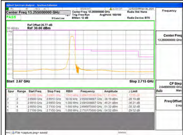
B41 / 20MHz / High CH / QPSK / 1 RB
