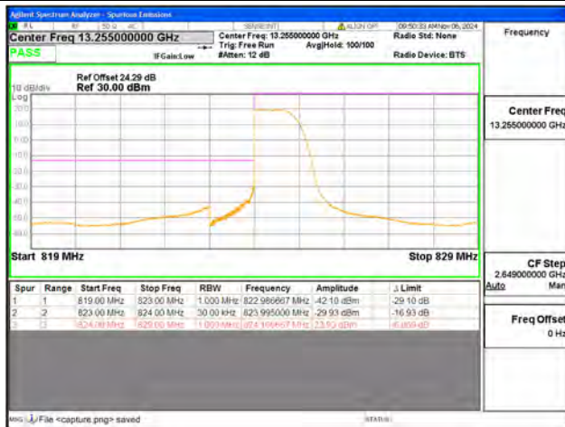
B5 / 5MHz / Low CH / QPSK / 1 RB
