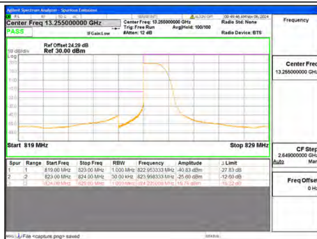
B5 / 3MHz / Low CH / QPSK / 1 RB
