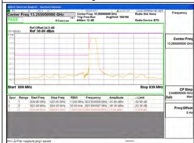
B26 / 15MHz / Low CH / QPSK / 1 RB
