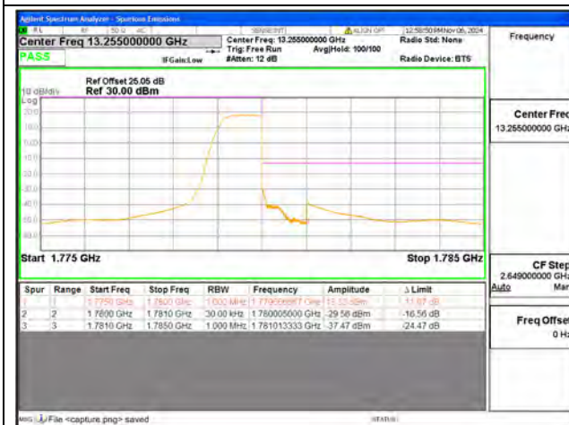
B66 / 5MHz / High CH / QPSK / 1 RB
