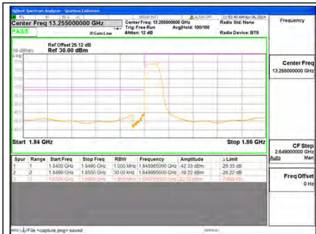
B25 / 10MHz / Low CH / QPSK / 1 RB
