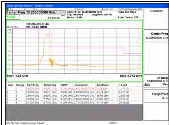
B41 / 10MHz / High CH / QPSK / 1 RB
