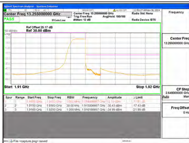
B25 / 5MHz / High CH / QPSK / 1 RB
